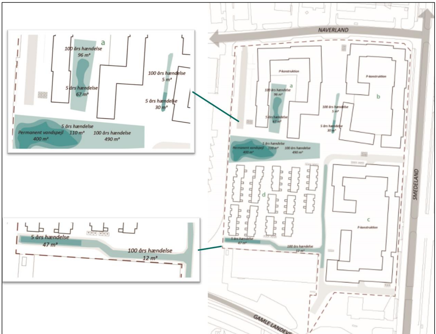
Figur 9-3. Forslag til fremtidig opmagasinering af 5-års og 100-års regnhændelse.
