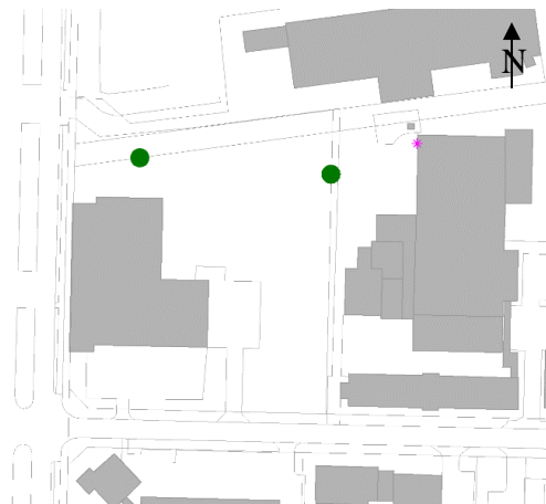
Figur 7: Situationsplan fra beregningsmodel for Tecotek. Støjkilden er markeret lyserød, modtagerpunkter som grønne prikker.
