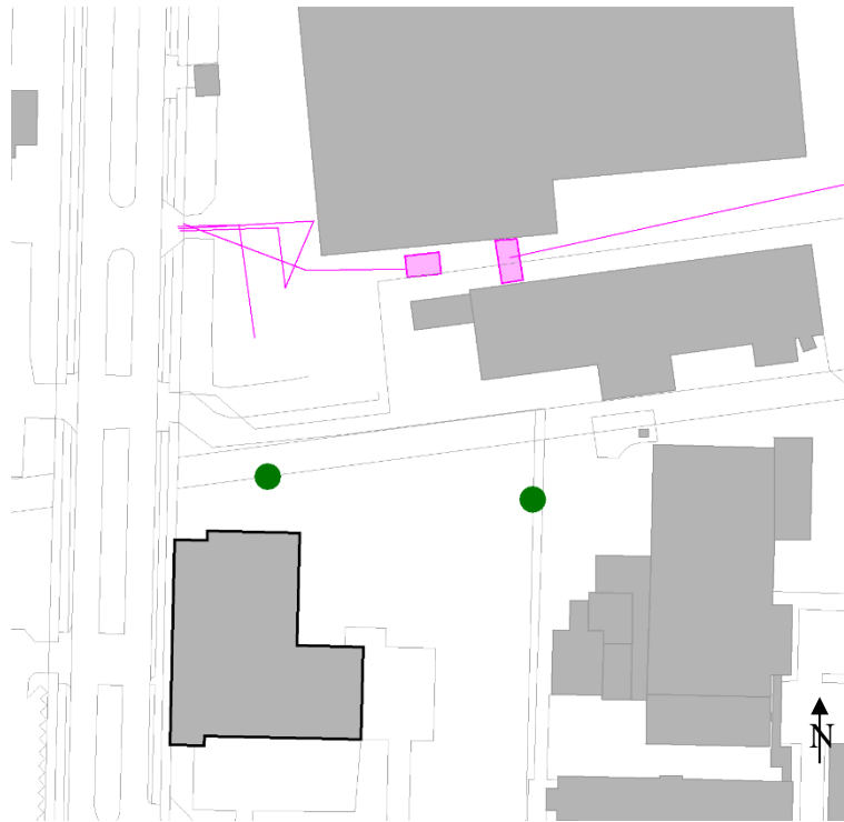
Figur 4: Situationsplan fra beregningsmodel for Elgiganten Logistik. Støjkilder er markeret lyserød, modtagerpunkter som grønne prikker.
