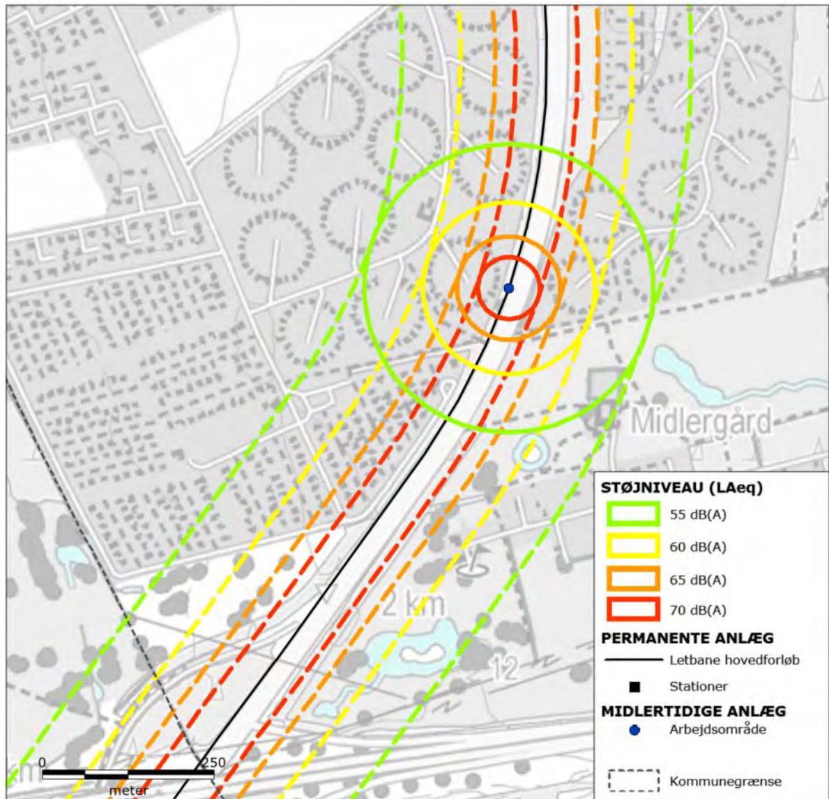
Figur 11-13 Støj fra etablering af letbanespor i den sydlige del af Brøndby Kommune. De fuldt optrukne signaturer (cirkler) omkranser de områder, der kan blive udsat for støj over 55, 60, 65 og 70 dB(A) fra etablering af letbanespor, der udføres i cirkelns centrum. Etableringen af letbanespor vil imidlertid flytte sig langs linjeføringen. De stiplede signaturer afgrænser derfor de områder, der på et tidspunkt i løbet af anlægsfasen kan blive udsat for støj over 55, 60, 65 og 70 dB(A).
