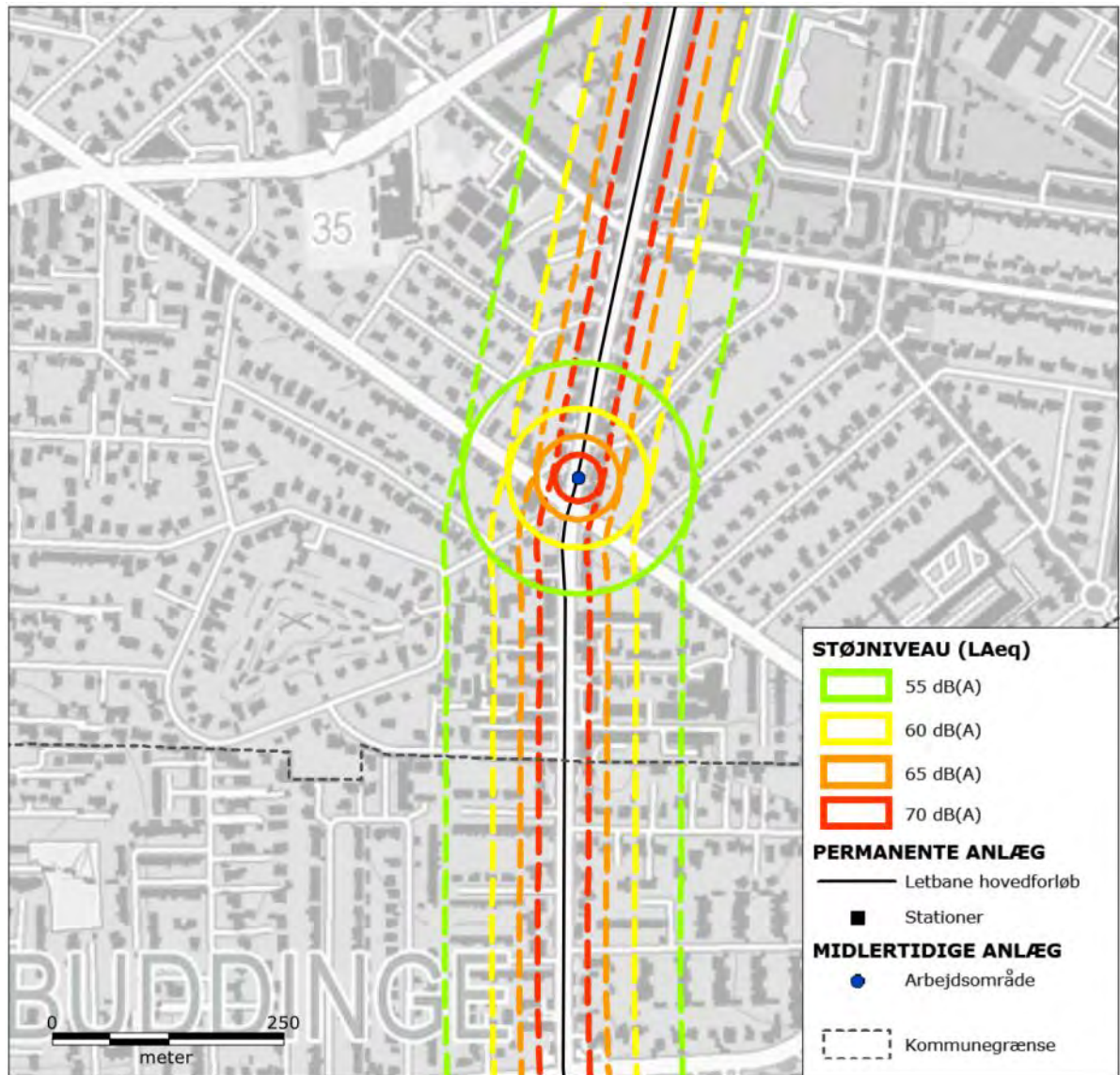
Figur 7-27 Støj fra etablering af køreledningsanlæg i den sydlige del af Lyngby-Taarbæk Kommune. De fuldt optrukne signaturer (cirkler) omkranser de områder, der kan blive udsat for støj over 55, 60, 65 og 70 dB(A) fra etablering af køreledningsanlæg, der udføres i cirklens centrum. Etableringen af køreledningsanlæg vil imidlertid flytte sig langs linjeføringen. De stiplede signaturer afgrænser derfor de områder, der på et tidspunkt i løbet af anlægsfasen kan blive udsat for støj over 55, 60, 65 og 70 dB(A).
