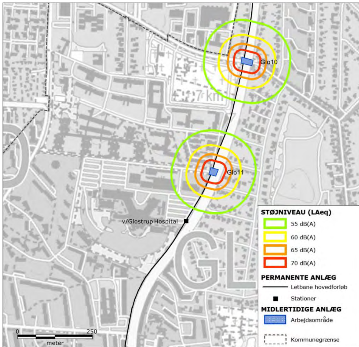
Figur 10-11 Støj fra ombygning af større kryds omkring Glostrup Hospital i Glostrup Kommune. Boliger inden for grøn, gul, orange og rød signatur kan blive udsat for støj over henholdsvis 55, 60, 65 og 70 dB(A).
