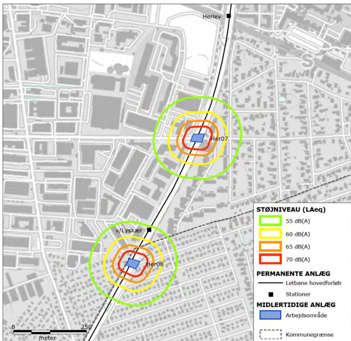
Figur 9-6 Støj fra ombygning af større kryds syd for Herlev Station i Herlev Kommune. Boliger inden for grøn, gul, orange og rød signatur kan blive udsat for støj over henholdsvis 55, 60, 65 og 70 dB(A).
