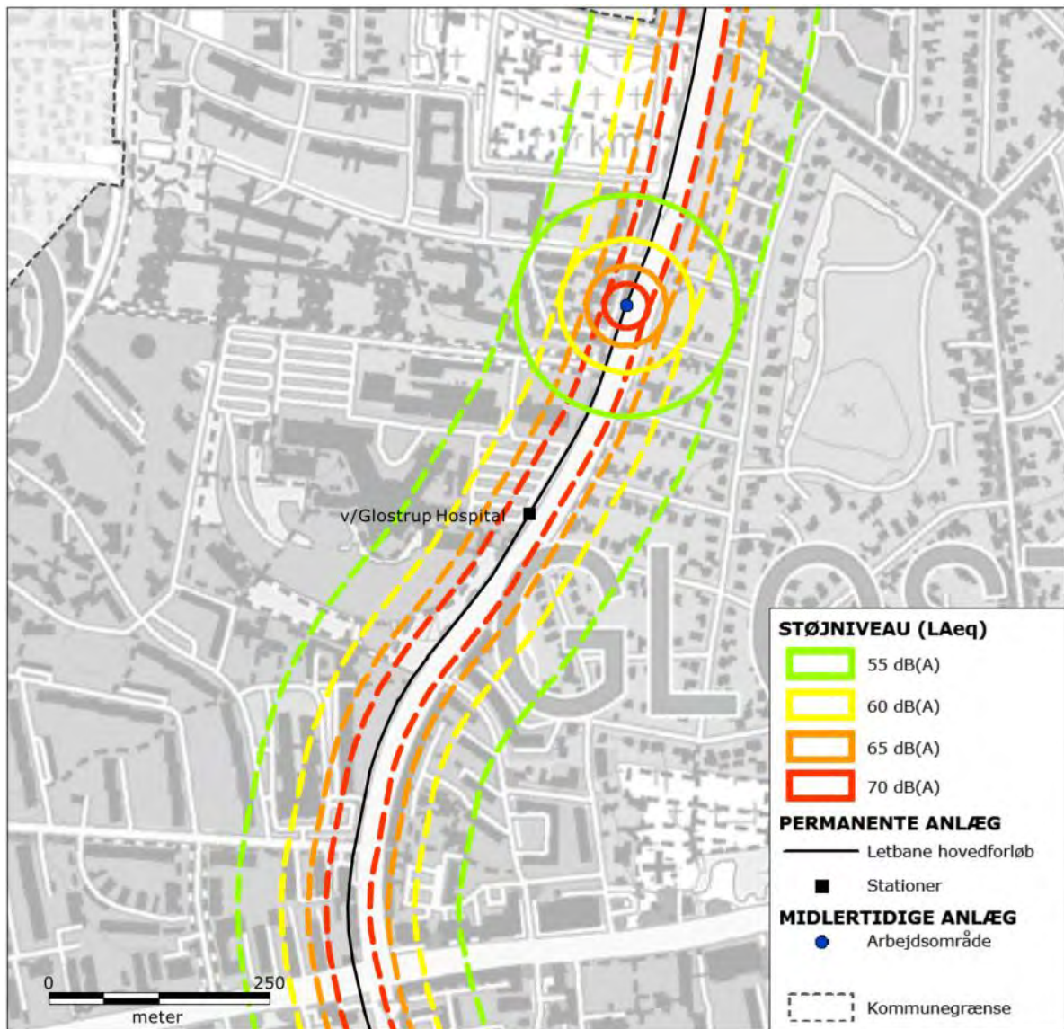
Figur 10-17 Støj fra ombygning af vejanlæg ved Glostrup Hospital i Glostrup Kommune. De fuldt optrukne signaturer (cirkler) omkranser de områder, der kan blive udsat for støj over 55, 60, 65 og 70 dB(A) fra en ombygning, der udføres i cirkelens centrum. Ombygningen af vejanlæg vil imidlertid flytte sig langs linjeføringen. De stiplede signaturer afgrænser derfor de områder, der på et tidspunkt i løbet af anlægsfasen kan blive udsat for støj over 55, 60, 65 og 70 dB(A).
