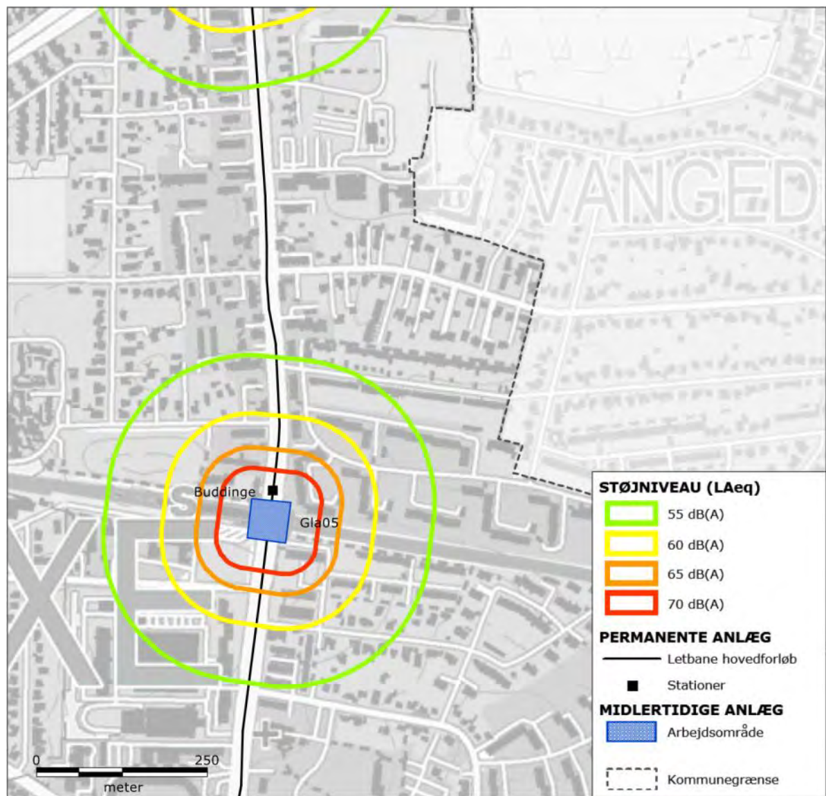
Figur 8-3 Støj fra bro- og tunnelarbejder ved Buddinge Station i Gladsaxe Kommune. Boliger inden for grøn, gul, orange og rød signatur kan blive udsat for støj over henholdsvis 55, 60, 65 og 70 dB(A).
