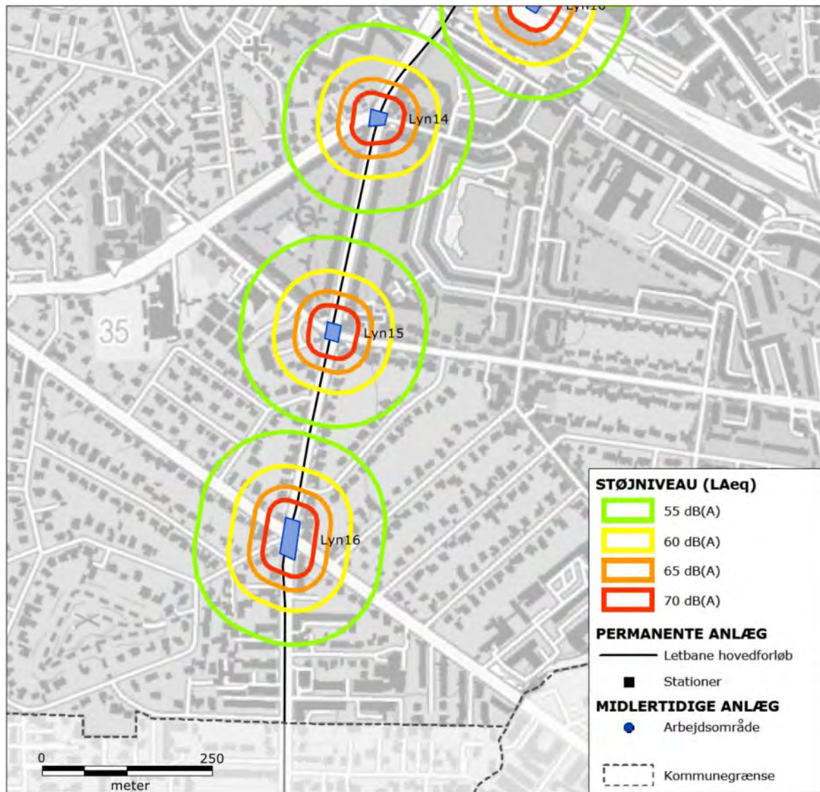
Figur 7-9 Støj fra ombygning af større kryds i den sydlige del af Lyngby-Taarbæk Kommune. Boliger inden for grøn, gul, orange og rød signatur kan blive udsat for støj over henholdsvis 55, 60, 65 og 70 dB(A).
