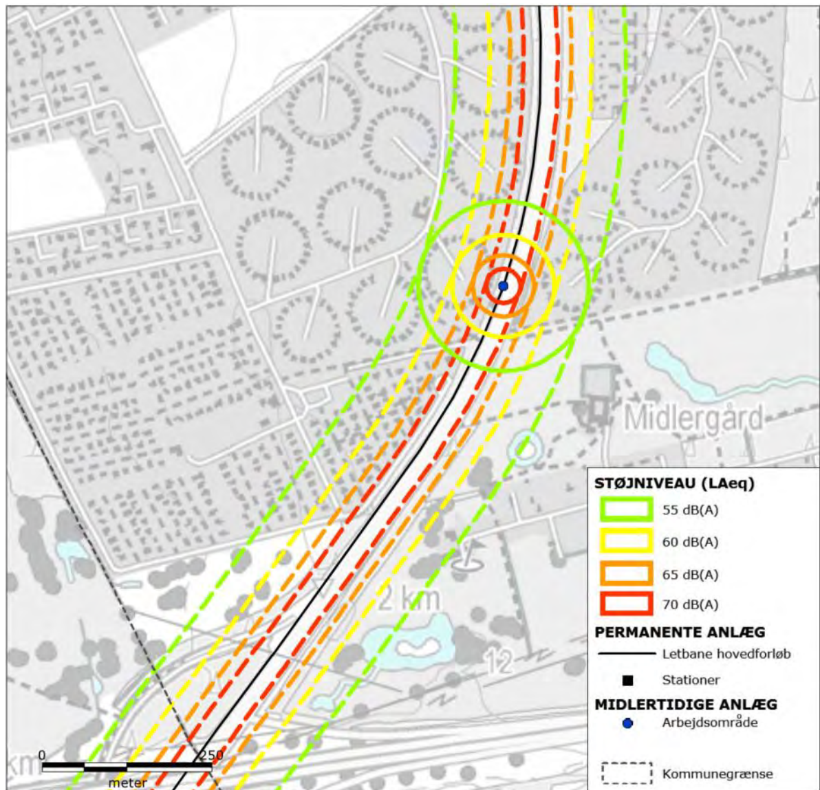
Figur 11-9 Støj fra ombygning af vejanlæg i den sydlige del af Brøndby Kommune. De fuldt optrukne signaturer (cirkler) omkranser de områder, der kan blive udsat for støj over 55, 60, 65 og 70 dB(A) fra en ombygning, der udføres i cirkelns centrum. Ombygningen af vejanlæg vil imidlertid flytte sig langs linjeføringen. De stiplede signaturer afgrænser derfor de områder, der på et tidspunkt i løbet af anlægsfasen kan blive udsat for støj over 55, 60, 65 og 70 dB(A).
