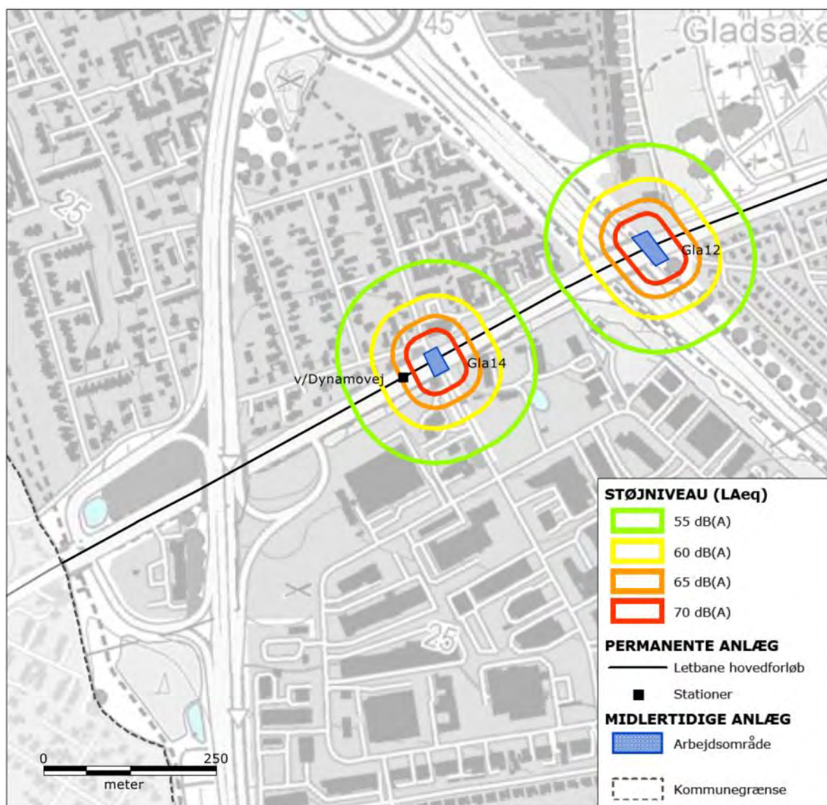
Figur 8-11 Støj fra ombygning af større kryds i den sydlige del af Gladsaxe Kommune. Boliger inden for grøn, gul, orange og rød signatur kan blive udsat for støj over henholdsvis 55, 60, 65 og 70 dB(A).
