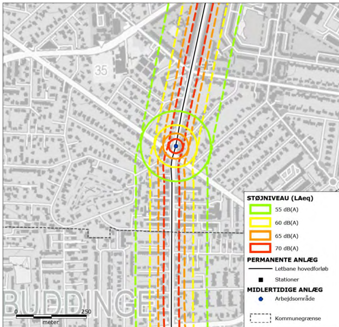
Figur 8-23 Støj fra etablering af køreledningsanlæg i den nordlige del af Gladsaxe Kommune. De fuldt optrukne signaturer (cirkler) omkranser de områder, der kan blive udsat for støj over 55, 60, 65 og 70 dB(A) fra etablering af køreledningsanlæg, der udføres i cirkelns centrum. Etableringen af køreledningsanlæg vil imidlertid flytte sig langs linjeføringen. De stiplede signaturer afgrænser derfor de områder, der på et tidspunkt i løbet af anlægsfasen kan blive udsat for støj over 55, 60, 65 og 70 dB(A).
