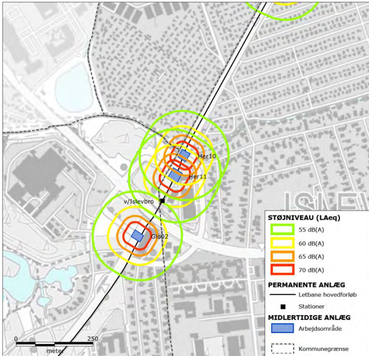
Figur 10-7 Støj fra ombygning af større kryds i den nordlige del af Glostrup Kommune. Boliger inden for grøn, gul, orange og rød signatur kan blive udsat for støj over henholdsvis 55, 60, 65 og 70 dB(A).
