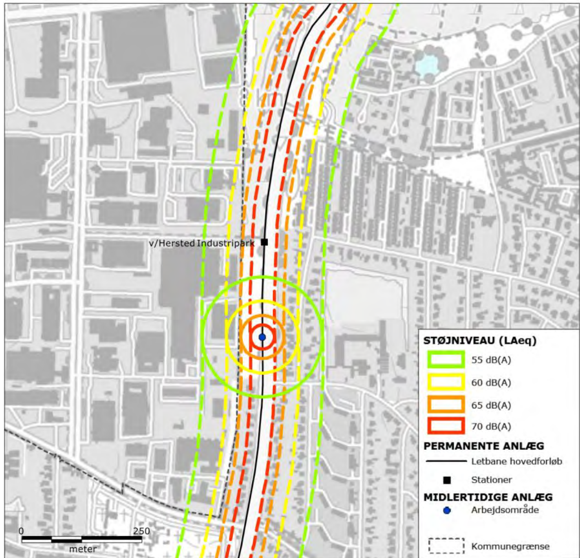
Figur 10-16 Støj fra ombygning af vejanlæg ved Hersted Industripark i Glostrup Kommune. De fuldt optrukne signaturer (cirkler) omkranser de områder, der kan blive udsat for støj over 55, 60, 65 og 70 dB(A) fra en ombygning, der udføres i cirkelns centrum. Ombygningen af vejanlæg vil imidlertid flytte sig langs linjeføringen. De stiplede signaturer afgrænser derfor de områder, der på et tidspunkt i løbet af anlægsfasen kan blive udsat for støj over 55, 60, 65 og 70 dB(A).
