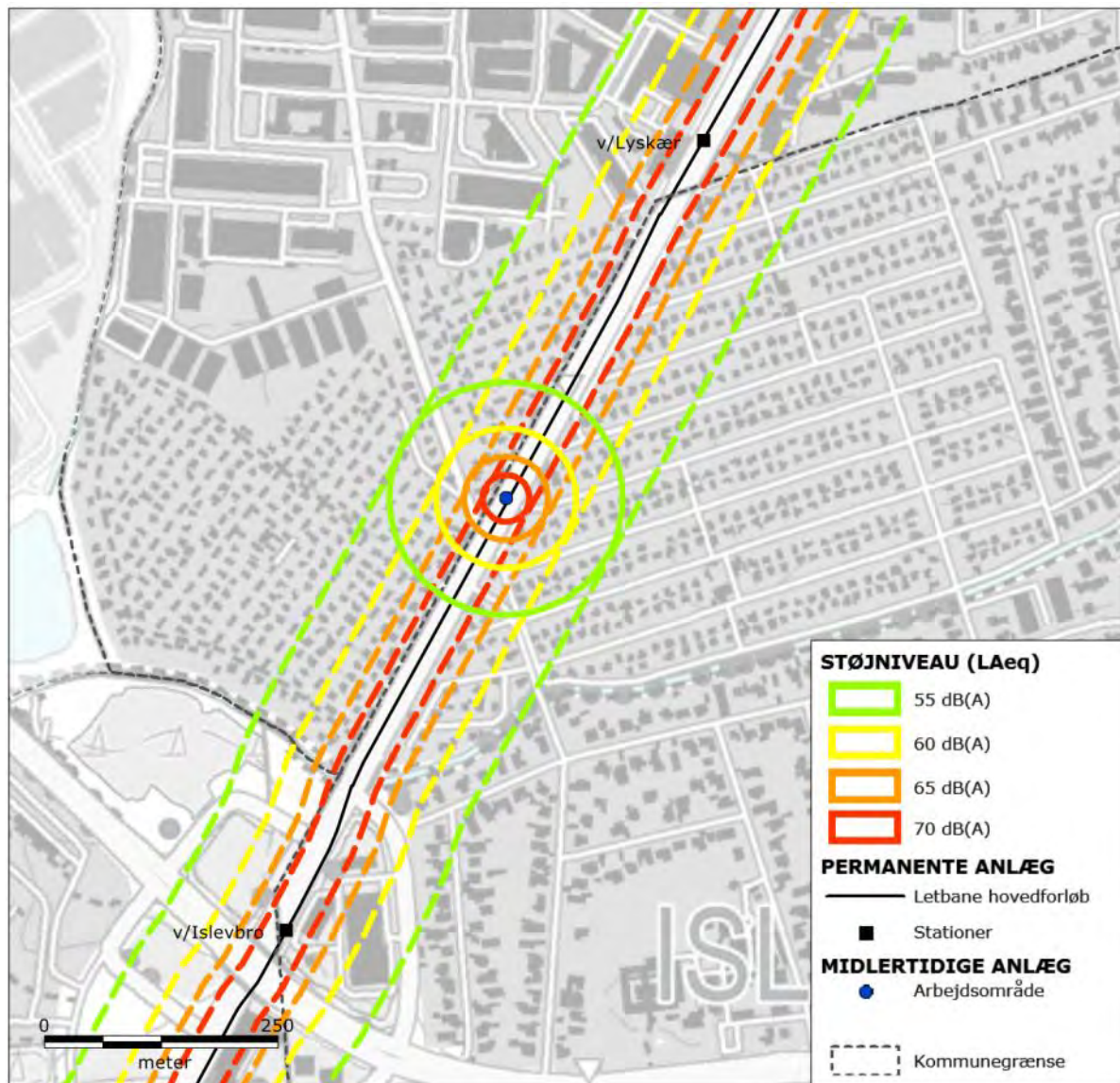
Figur 9-10 Støj fra ombygning af vejanlæg i den sydlige del af Herlev Kommune og den nordlige del af Rødovre Kommune. De fuldt optrukne signaturer (cirkler) omkranser de områder, der kan blive udsat for støj over 55, 60, 65 og 70 dB(A) fra en ombygning, der udføres i cirkelns centrum. Ombygningen af vejanlæg vil imidlertid flytte sig langs linjeføringen. De stiplede signaturer afgrænser derfor de områder, der på et tidspunkt i løbet af anlægsfasen kan blive udsat for støj over 55, 60, 65 og 70 dB(A).
