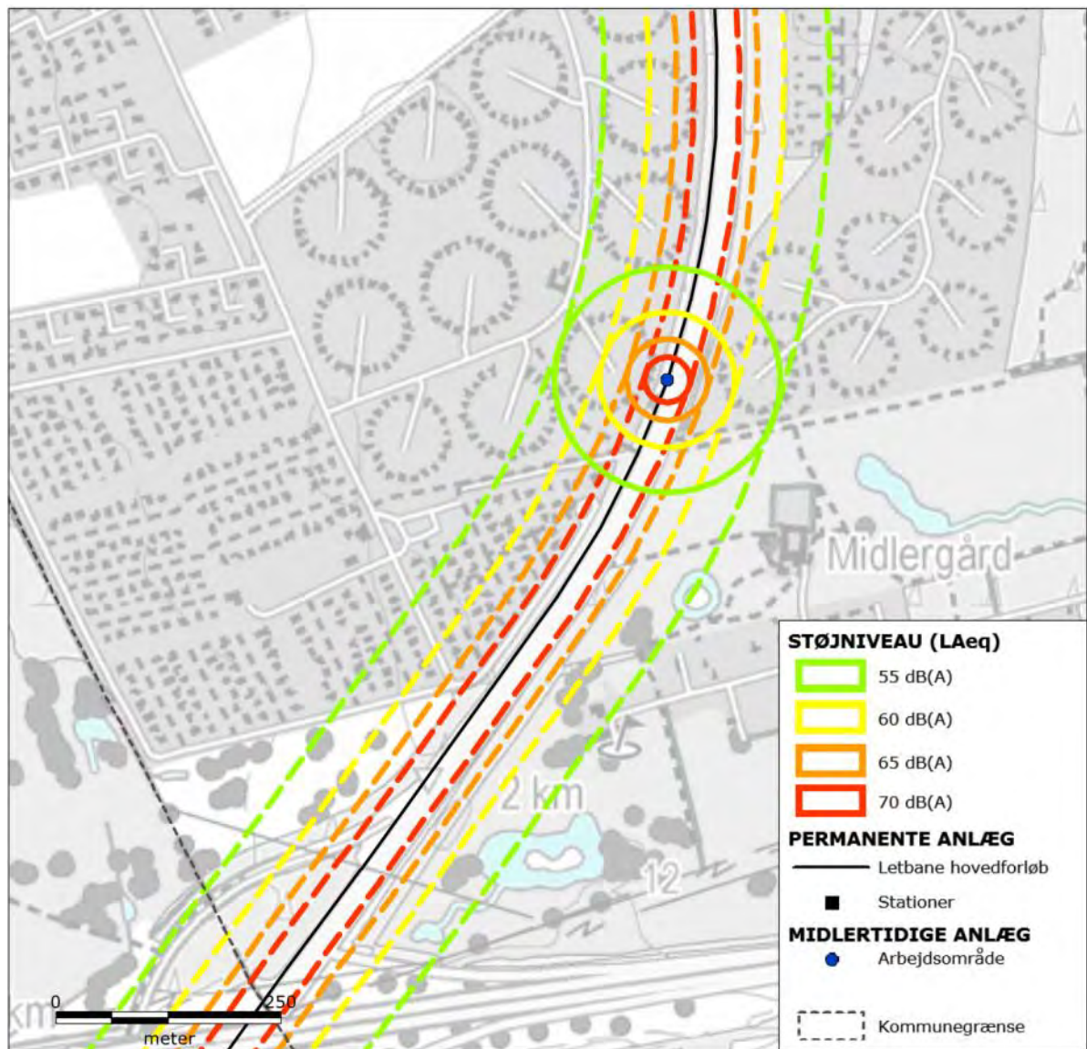
Figur 11-17 Støj fra etablering af køreledningsanlæg i den sydlige del af Brøndby Kommune. De fuldt optrukne signaturer (cirkler) omkranser de områder, der kan blive udsat for støj over 55, 60, 65 og 70 dB(A) fra etablering af køreledningsanlæg, der udføres i cirkelens centrum. Etableringen af køreledningsanlæg vil imidlertid flytte sig langs linjeføringen. De stiplede signaturer afgrænser derfor de områder, der på et tidspunkt i løbet af anlægsfasen kan blive udsat for støj over 55, 60, 65 og 70 dB(A).
