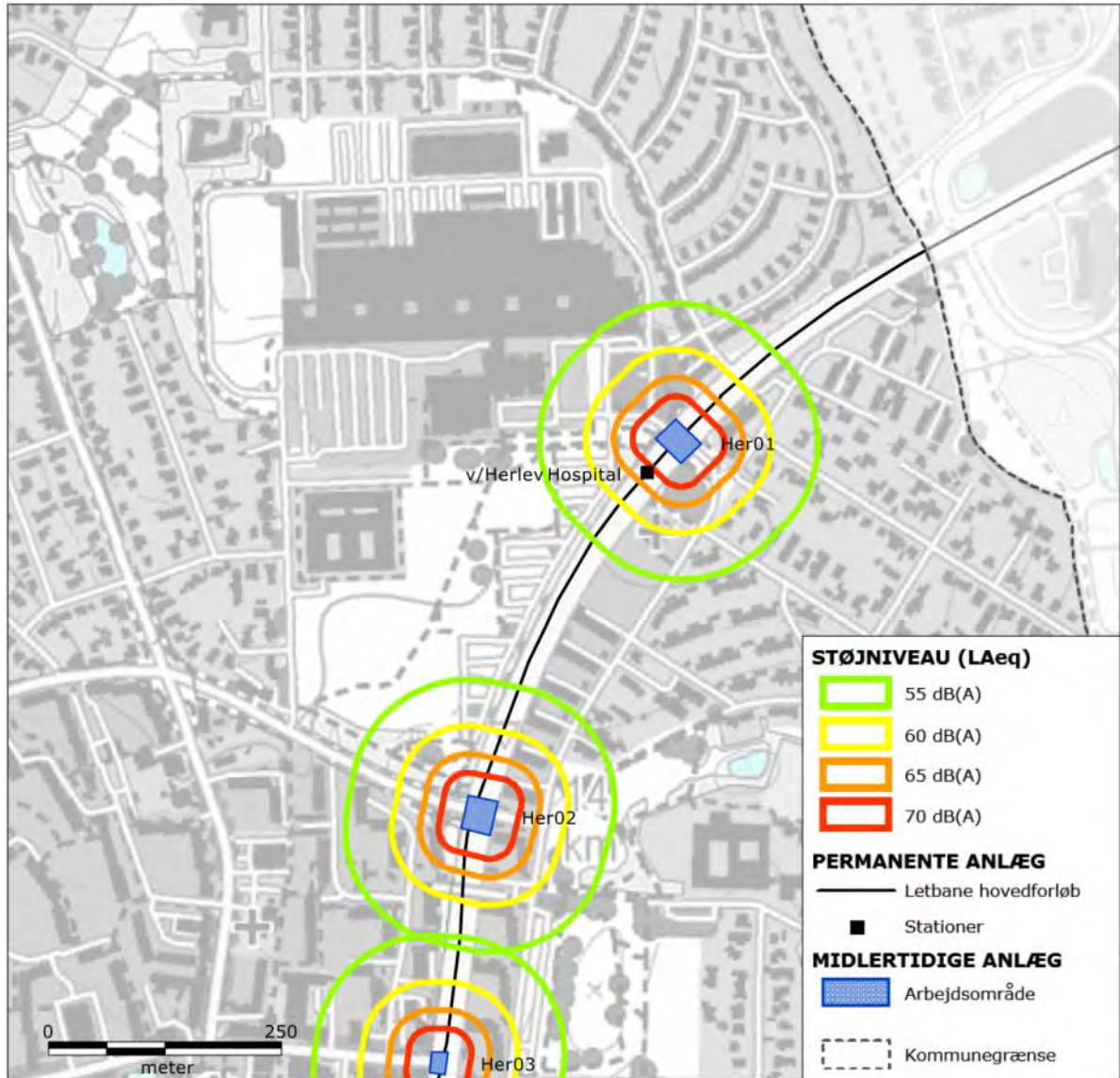
Figur 9-4 Støj fra ombygning af større kryds i den nordlige del af Herlev Kommune. Boliger inden for grøn, gul, orange og rød signatur kan blive udsat for støj over henholdsvis 55, 60, 65 og 70 dB(A).
