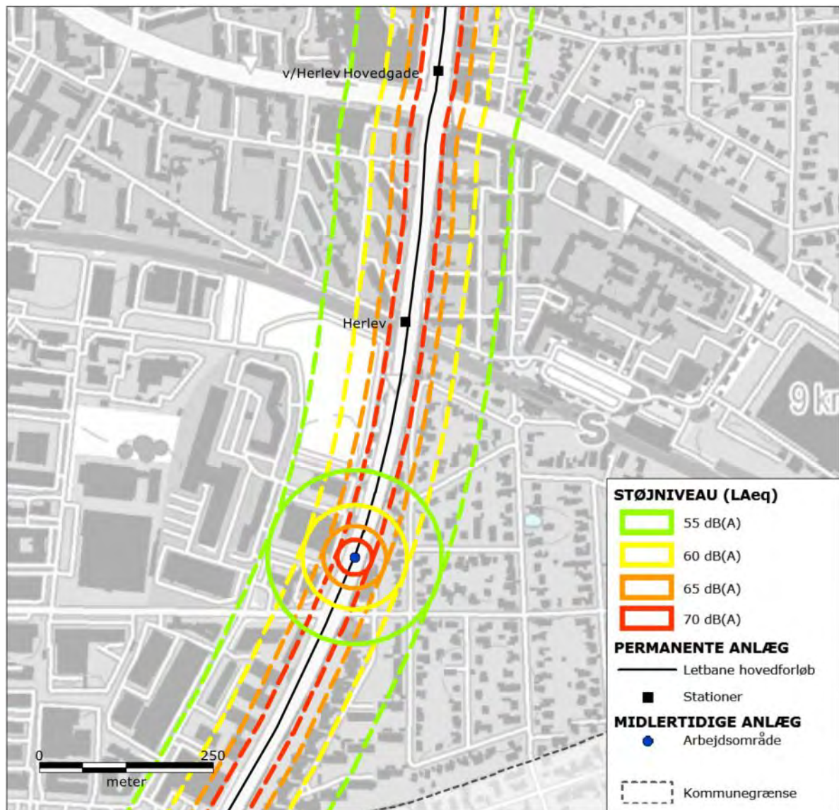
Figur 9-9 Støj fra ombygning af vejanlæg ved Herlev Station i Herlev Kommune. De fuldt optrukne signaturer (cirkler) omkranser de områder, der kan blive udsat for støj over 55, 60, 65 og 70 dB(A) fra en ombygning, der udføres i cirkelens centrum. Ombygningen af vejanlæg vil imidlertid flytte sig langs linjeføringen. De stiplede signaturer afgrænser derfor de områder, der på et tidspunkt i løbet af anlægsfasen kan blive udsat for støj over 55, 60, 65 og 70 dB(A).
