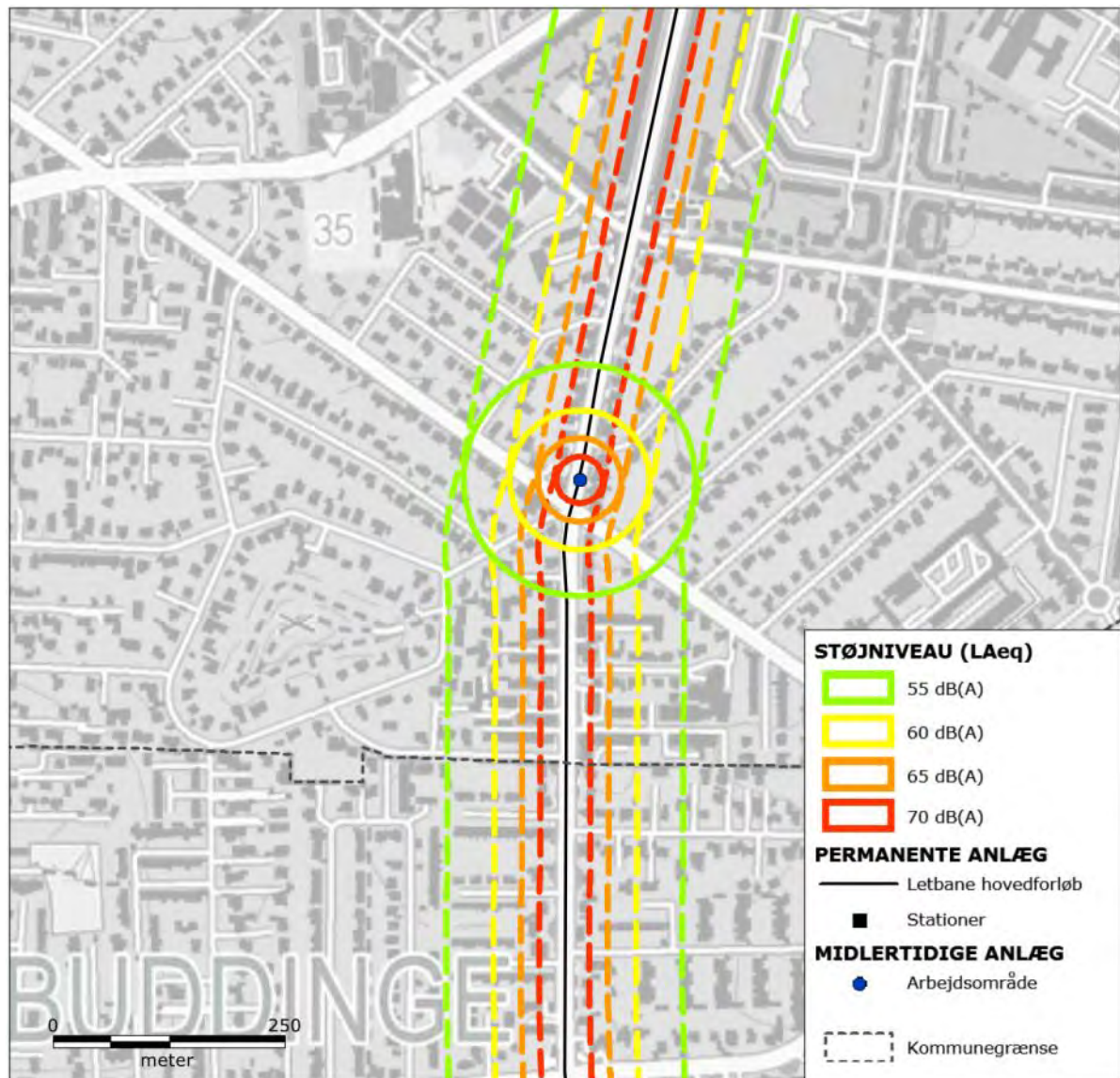
Figur 7-15 Støj fra ombygning af vejanlæg i den sydlige del af Lyngby-Taarbæk Kommune. De fuldt optrukne signaturer (cirkler) omkranser de områder, der kan blive udsat for støj over 55, 60, 65 og 70 dB(A) fra en ombygning, der udføres i cirkelens centrum. Ombygningen af vejanlæg vil imidlertid flytte sig langs linjeføringen. De stiplede signaturer afgrænser derfor de områder, der på et tidspunkt i løbet af anlægsfasen kan blive udsat for støj over 55, 60, 65 og 70 dB(A).
