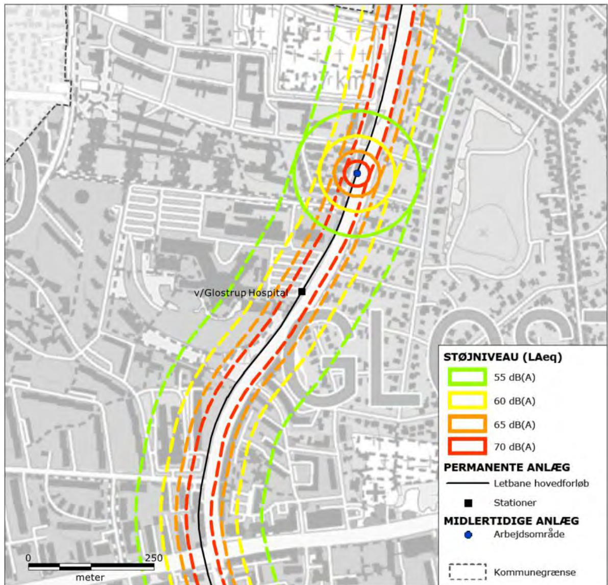
Figur 10-29 Støj fra etablering af køreledningsanlæg ved Glostrup Hospital i Glostrup Kommune. De fuldt optrukne signaturer (cirkler) omkranser de områder, der kan blive udsat for støj over 55, 60, 65 og 70 dB(A) fra etablering af køreledningsanlæg, der udføres i cirkelns centrum. Etableringen af køreledningsanlæg vil imidlertid flytte sig langs linjeføringen. De stiplede signaturer afgrænser derfor de områder, der på et tidspunkt i løbet af anlægsfasen kan blive udsat for støj over 55, 60, 65 og 70 dB(A).
