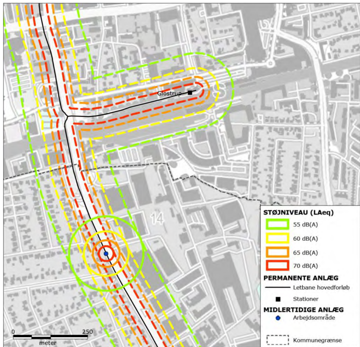
Figur 11-14 Støj fra etablering af køreledningsanlæg i den nordlige del af Brøndby Kommune. De fuldt optrukne signaturer (cirkler) omkranser de områder, der kan blive udsat for støj over 55, 60, 65 og 70 dB(A) fra etablering af køreledningsanlæg, der udføres i cirkelns centrum. Etableringen af køreledningsanlæg vil imidlertid flytte sig langs linjeføringen. De stiplede signaturer afgrænser derfor de områder, der på et tidspunkt i løbet af anlægsfasen kan blive udsat for støj over 55, 60, 65 og 70 dB(A).
