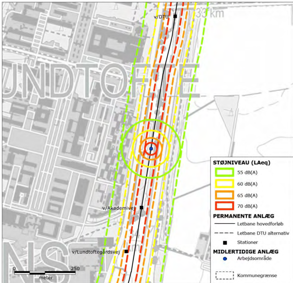
Figur 7-23 Støj fra etablering af køreledningsanlæg ved DTU, for hovedforslaget i Lyngby-Taarbæk Kommune. De fuldt optrukne signaturer (cirkler) omkranser de områder, der kan blive udsat for støj over 55, 60, 65 og 70 dB(A) fra etablering af køreledningsanlæg, der udføres i cirkelns centrum. Etableringen af køreledningsanlæg vil imidlertid flytte sig langs linjeføringen. De stiplede signaturer afgrænser derfor de områder, der på et tidspunkt i løbet af anlægsfasen kan blive udsat for støj over 55, 60, 65 og 70 dB(A).
