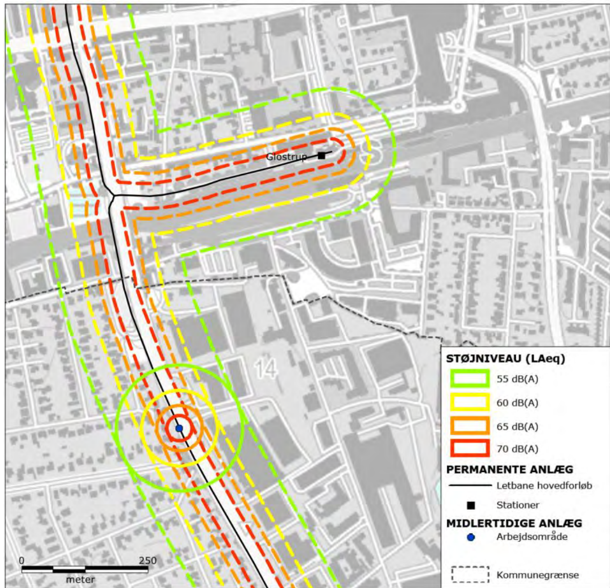
Figur 11-6 Støj fra ombygning af vejanlæg i den nordlige del af Brøndby Kommune. De fuldt optrukne signaturer (cirkler) omkranser de områder, der kan blive udsat for støj over 55, 60, 65 og 70 dB(A) fra en ombygning, der udføres i cirklens centrum. Ombygningen af vejanlæg vil imidlertid flytte sig langs linjeføringen. De stiplede signaturer afgrænser derfor de områder, der på et tidspunkt i løbet af anlægsfasen kan blive udsat for støj over 55, 60, 65 og 70 dB(A).
