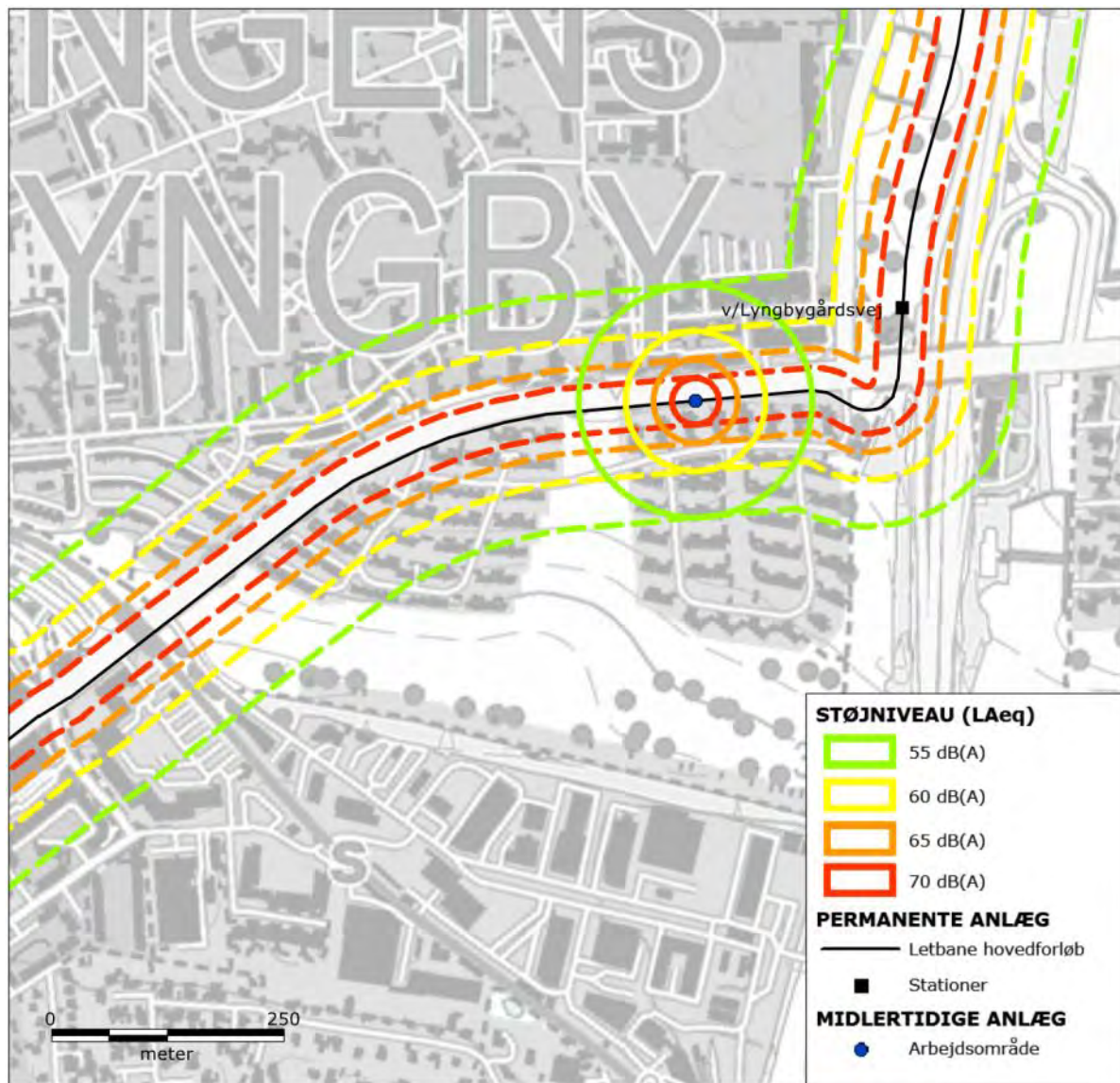
Figur 7-25 Støj fra etablering af køreledningsanlæg ved Lyngbygårdsvej i Lyngby-Taarbæk Kommune. De fuldt optrukne signaturer (cirkler) omkranser de områder, der kan blive udsat for støj over 55, 60, 65 og 70 dB(A) fra etablering af køreledningsanlæg, der udføres i cirklens centrum. Etableringen af køreledningsanlæg vil imidlertid flytte sig langs linjeføringen. De stiplede signaturer afgrænser derfor de områder, der på et tidspunkt i løbet af anlægsfasen kan blive udsat for støj over 55, 60, 65 og 70 dB(A).
