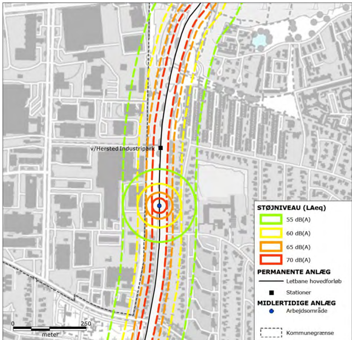
Figur 10-28 Støj fra etablering af køreledningsanlæg ved Hersted Industripark i Glostrup Kommune. De fuldt optrukne signaturer (cirkler) omkranser de områder, der kan blive udsat for støj over 55, 60, 65 og 70 dB(A) fra etablering af køreledningsanlæg, der udføres i cirkelns centrum. Etableringen af køreledningsanlæg vil imidlertid flytte sig langs linjeføringen. De stiplede signaturer afgrænser derfor de områder, der på et tidspunkt i løbet af anlægsfasen kan blive udsat for støj over 55, 60, 65 og 70 dB(A).
