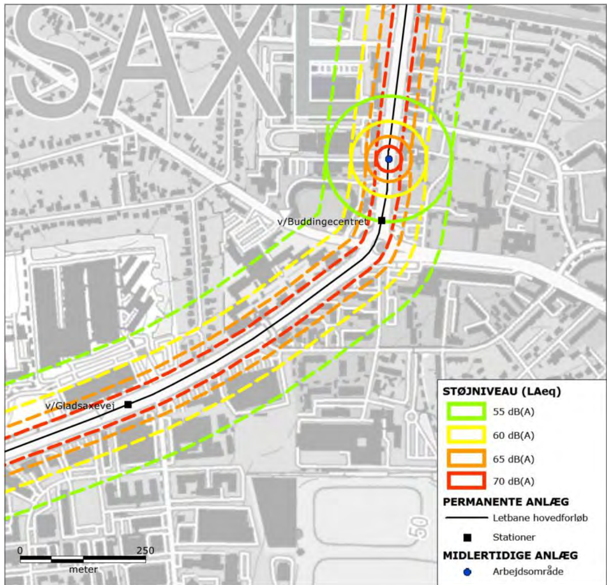
Figur 8-25 Støj fra etablering af køreledningsanlæg ved Buddingecentret i Gladsaxe Kommune. De fuldt optrukne signaturer (cirkler) omkranser de områder, der kan blive udsat for støj over 55, 60, 65 og 70 dB(A) fra etablering af køreledningsanlæg, der udføres i cirkelns centrum. Etableringen af køreledningsanlæg vil imidlertid flytte sig langs linjeføringen. De stiplede signaturer afgrænser derfor de områder, der på et tidspunkt i løbet af anlægsfasen kan blive udsat for støj over 55, 60, 65 og 70 dB(A).
