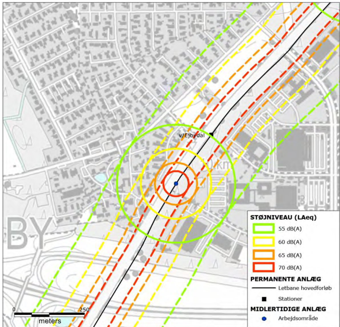
Figur 10-20 Støj fra etablering af letbanespor ved Ejbydal i Glostrup Kommune. De fuldt optrukne signaturer (cirkler) omkranser de områder, der kan blive udsat for støj over 55, 60, 65 og 70 dB(A) fra etablering af letbanespor, der udføres i cirkelens centrum. Etableringen af letbanespor vil imidlertid flytte sig langs linjeføringen. De stiplede signaturer afgrænser derfor de områder, der på et tidspunkt i løbet af anlægsfasen kan blive udsat for støj over 55, 60, 65 og 70 dB(A).
