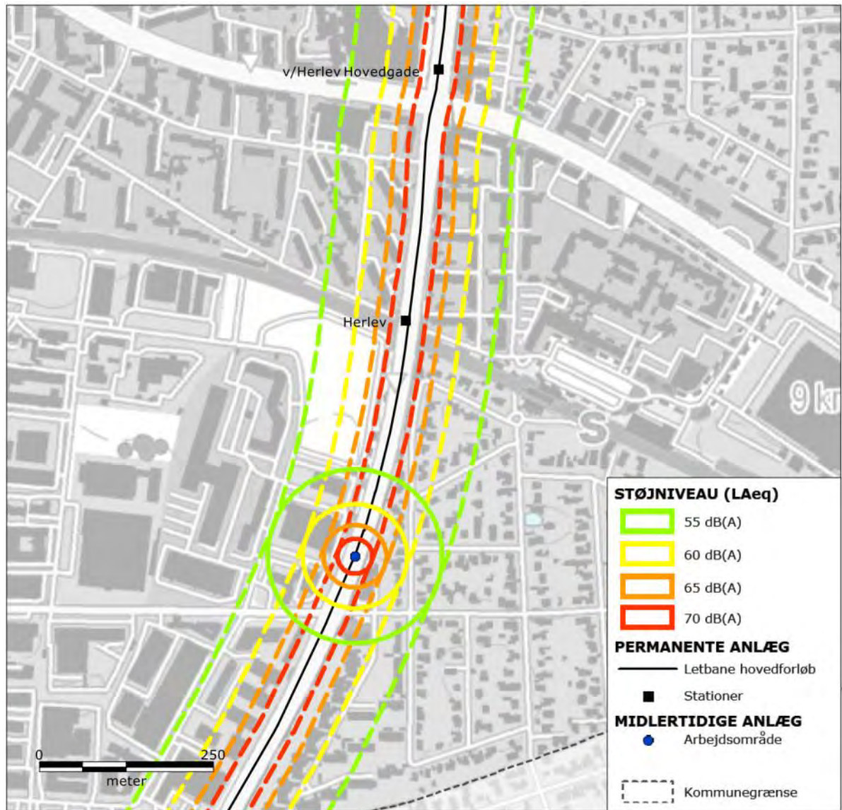
Figur 9-15 Støj fra etablering af køreledningsanlæg ved Herlev Station i Herlev Kommune. De fuldt optrukne signaturer (cirkler) omkranser de områder, der kan blive udsat for støj over 55, 60, 65 og 70 dB(A) fra etablering af køreledningsanlæg, der udføres i cirklens centrum. Etableringen af køreledningsanlæg vil imidlertid flytte sig langs linjeføringen. De stiplede signaturer afgrænser derfor de områder, der på et tidspunkt i løbet af anlægsfasen kan blive udsat for støj over 55, 60, 65 og 70 dB(A).
