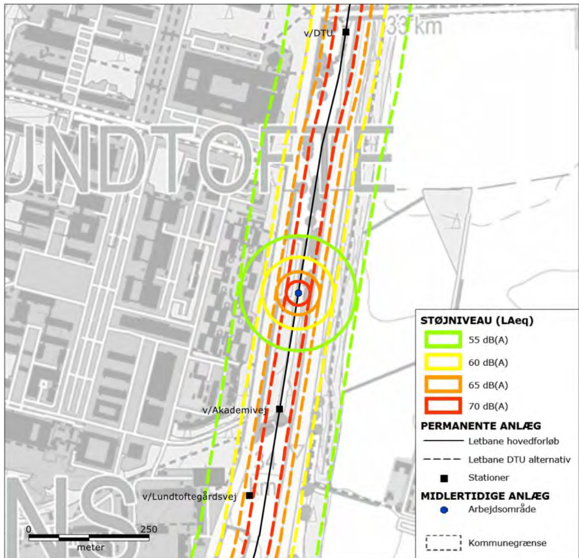
Figur 7-11 Støj fra ombygning af vejanlæg ved DTU, for hovedforslaget i Lyngby-Taarbæk Kommune. De fuldt optrukne signaturer (cirkler) omkranser de områder, der kan blive udsat for støj over 55, 60, 65 og 70 dB(A) fra en ombygning, der udføres i cirkelens centrum. Ombygningen af vejanlæg vil imidlertid flytte sig langs linjeføringen. De stiplede signaturer afgrænser derfor de områder, der på et tidspunkt i løbet af anlægsfasen kan blive udsat for støj over 55, 60, 65 og 70 dB(A).
