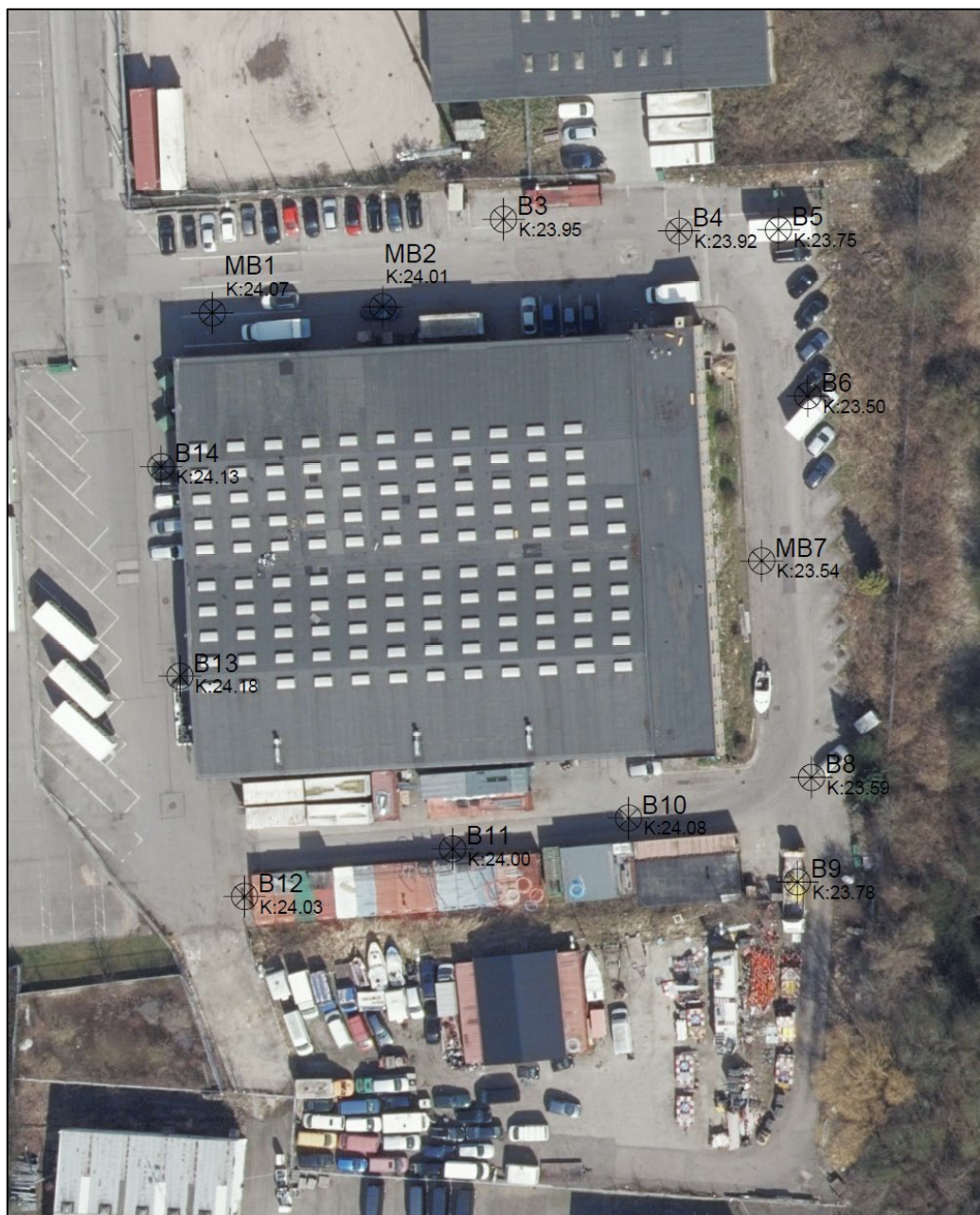
Figur 11.4: Placering af de 14 geotekniske borer udført i september 2022 / bilag DJMG georap /.
