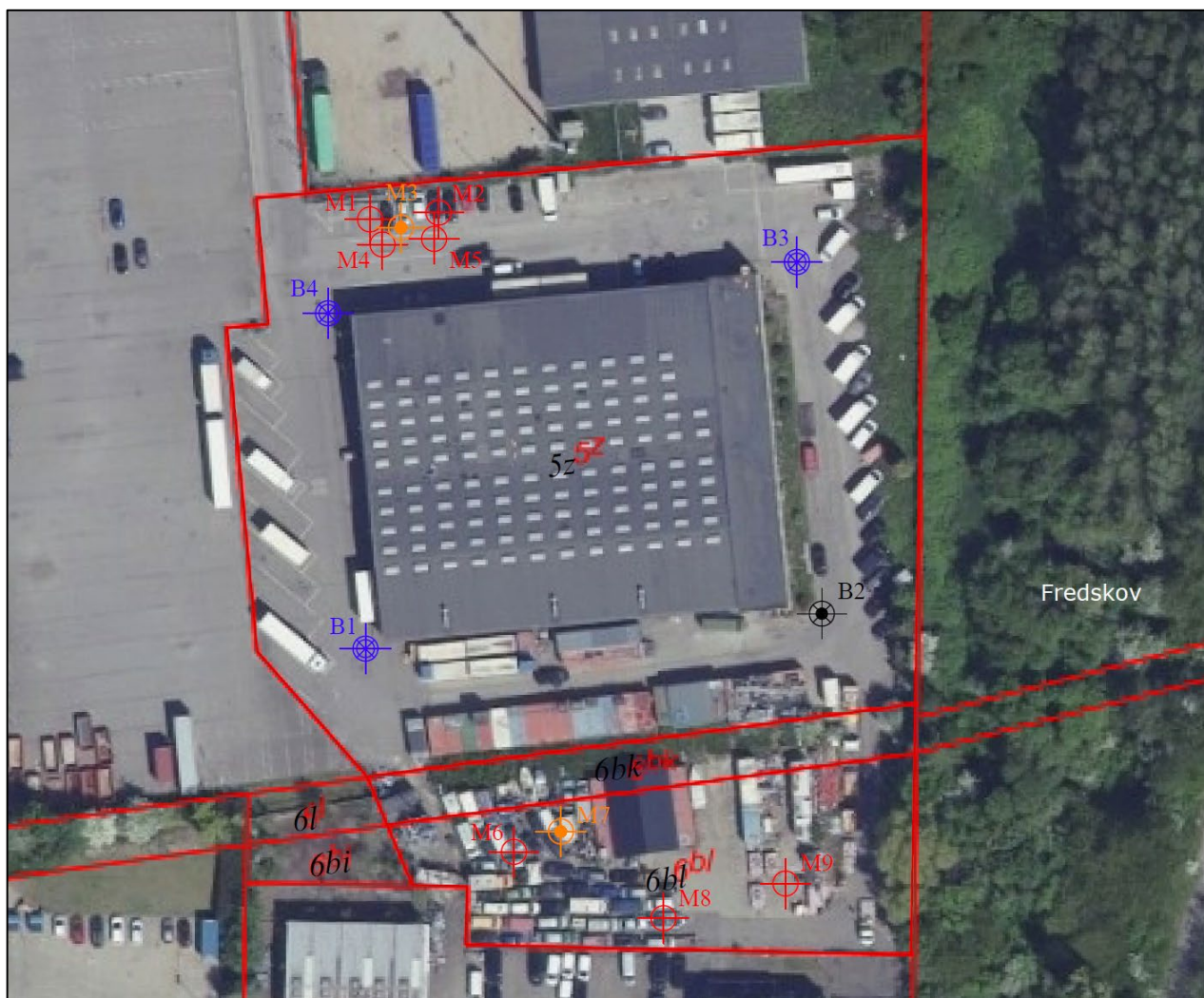
Figur 10.6: Placering af borer i forbindelse med den kombinerede miljø- og geotekniske undersøgelse i 2021 / bilag Jord Miljø /.
