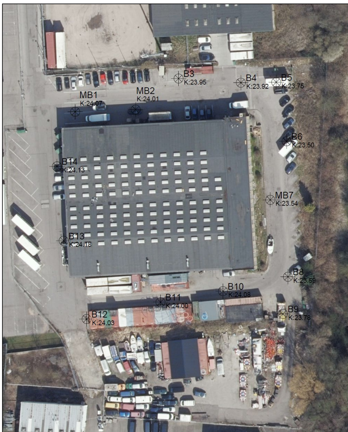
Figur 10.4: Placering af de 14 geotekniske borer udført i september 2022 /bilag DJMG georap/ .
