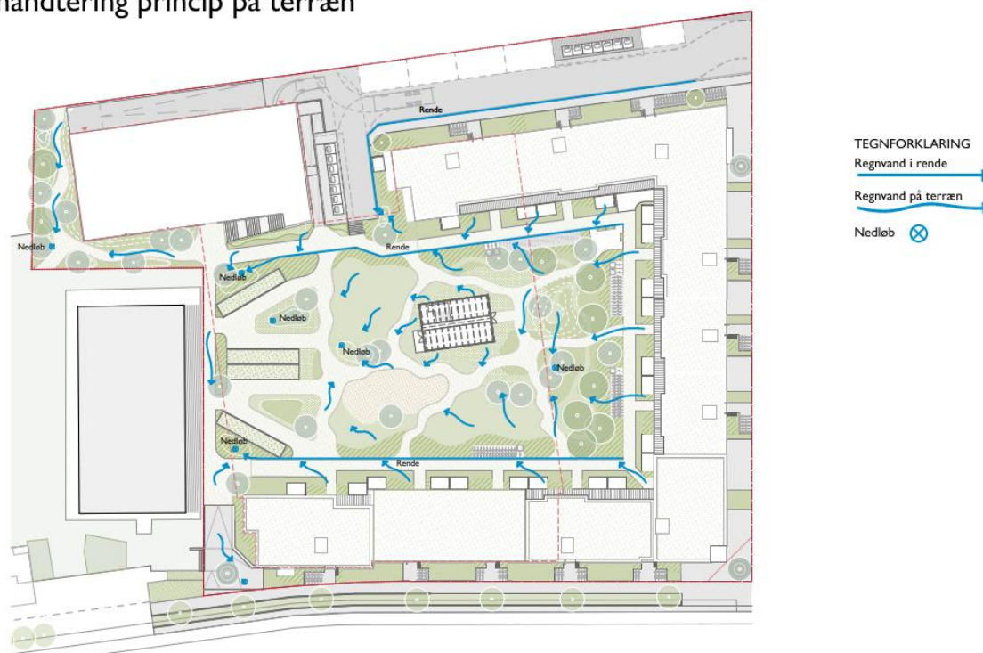
Figur 9: Princip for vandføring på terræn.
