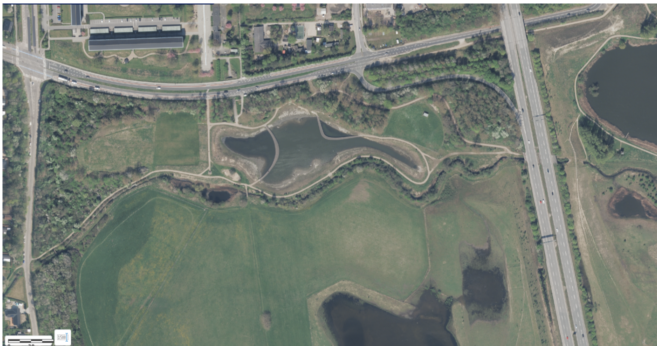
Figur 3: Luftfoto af Haraldsminde med den permanente regnvandssø, driftsveje og rekreative stier, herunder to plankebroer i søen, som området vil se ud under normal hverdagsregn. Harrestrup Å forløber på sydsiden af regnvandssøen. Sluseanlægget er placeret nedstrøms fra Haraldsminde (se også Figur 2).
