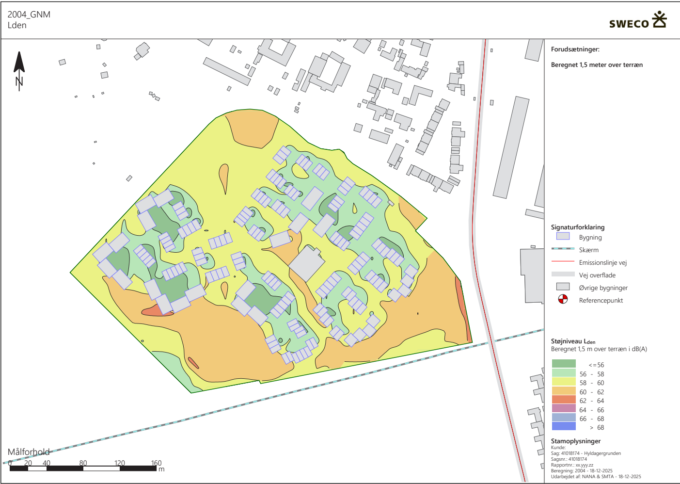
Beregning med alle facader støjabsorberende (refleksionstab 3 dB, svarende til en gennemsnitlig absorptionskoefficient på 0,5).
