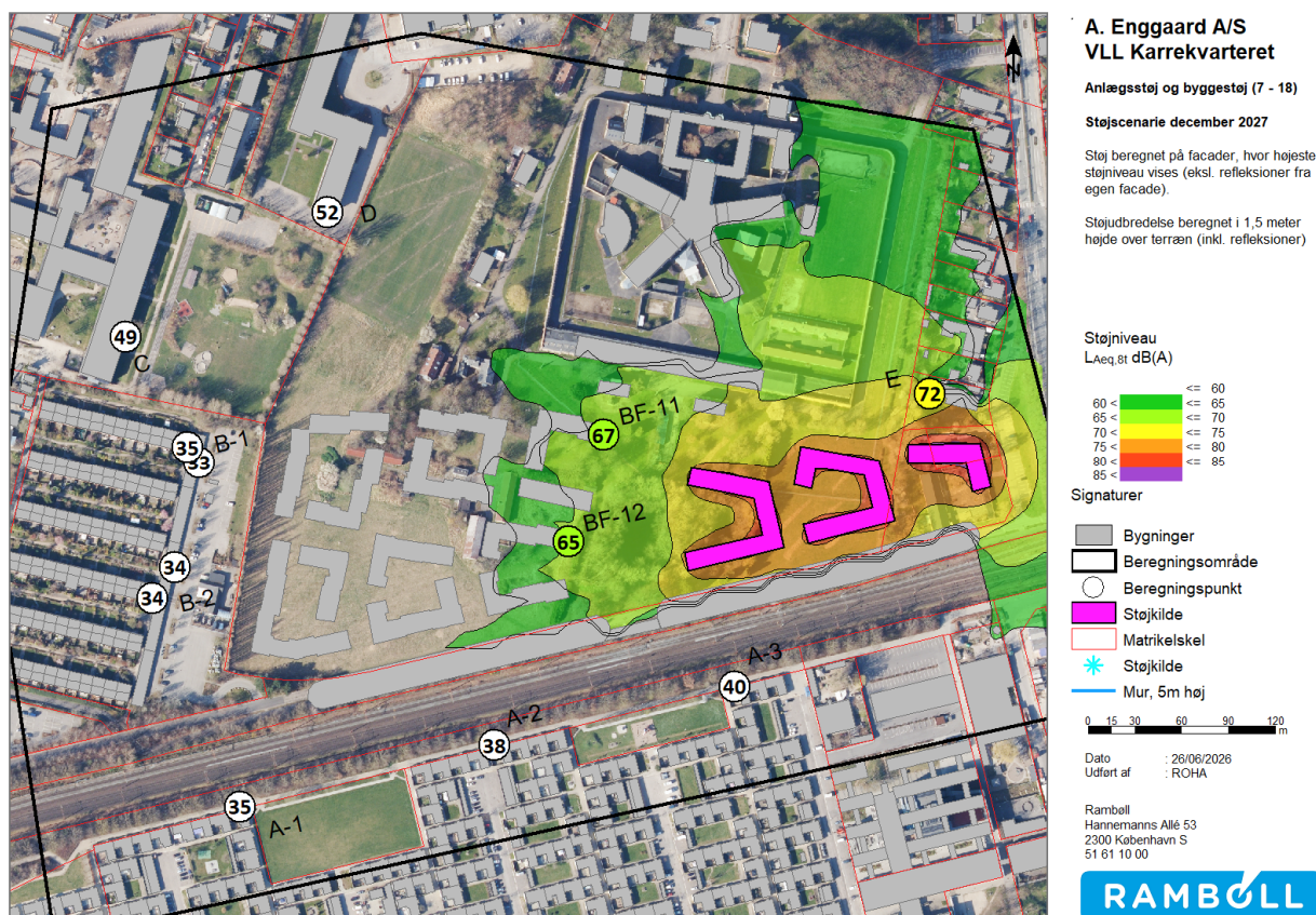
Figur 7-4. Støj på facader og støjudbredelse for scenarie nr.4 i december 2027, hvor alle bygninger i V10 samt enkelte i V20 er klar til ibrugtagelse, mens der stadig er byggeaktivitet i en del af område V20. Støjniveauer i cirkler er beregnet på facaden af bygninger, hvor det højeste støjniveau vises. Støjniveauet er beregnet som en worst-case situation.
