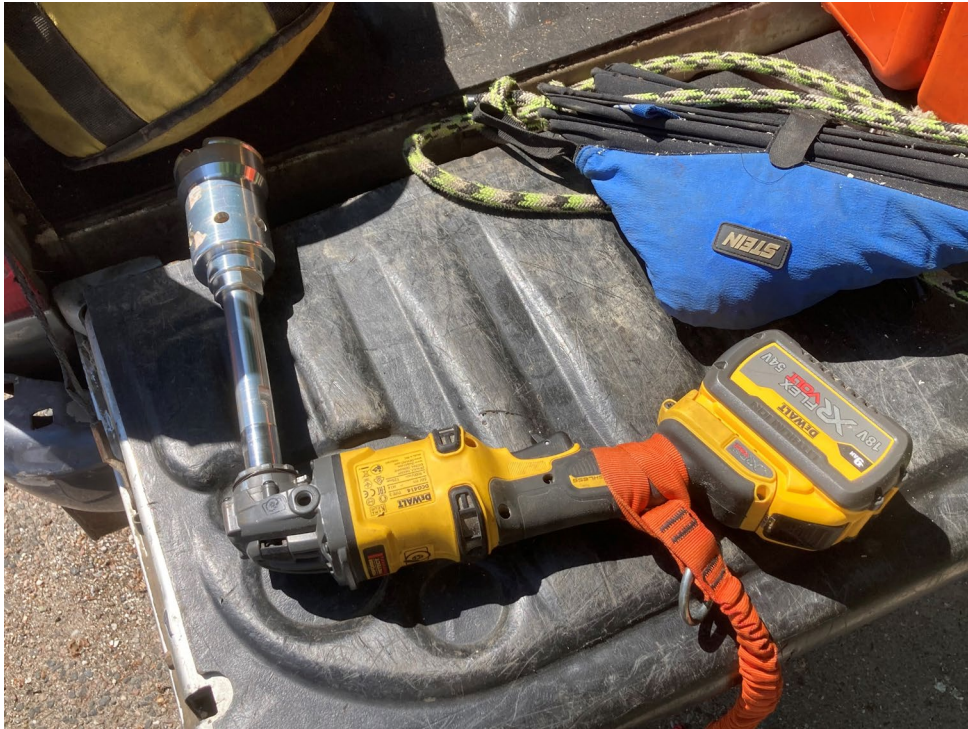
Figur 3 Vinkelsliber monteret med specialbor
