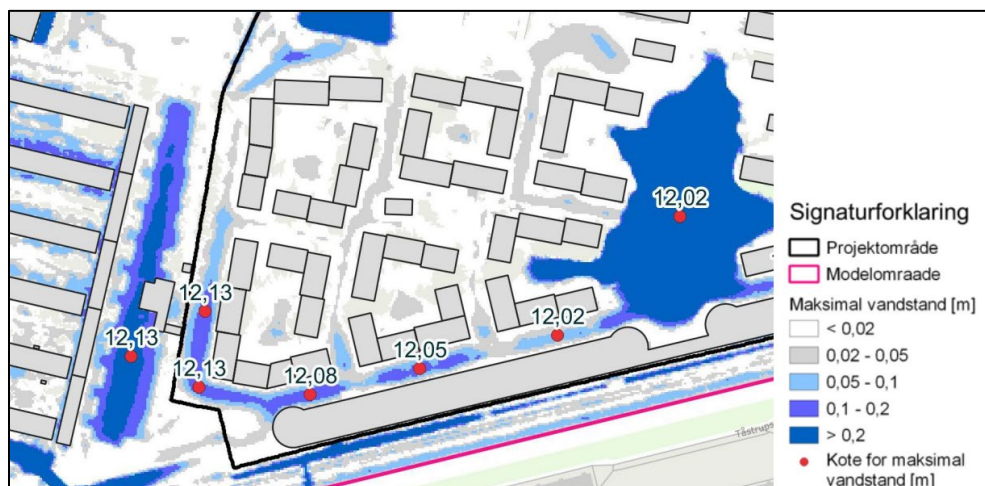
Figur 6-17 Diagram fra beregningsmodellen Mike Flood, som viser maksimal vanddybde samt vandstandskote i lokalplanområdet, ved en 100-årshændelse om 100 år. Kilde: WSP.
