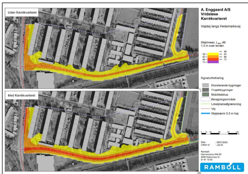
Figur 6-9 Vejstøjens udbredelse langs Hedemarksvej. Ved fladeberegninger er vejstøjen ikke beregnet som fritfeltsværdier, hvorfor støjniveauet nær bygningfacader kan være op til 3 dB højere end fritfeltsværdier på facaderne. Bilag 3 Trafikstøj Vridsløse SV
