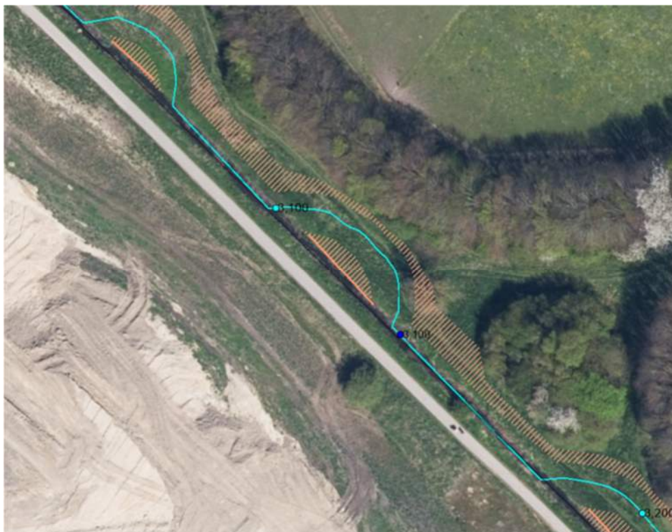
Figur 3-4 Princip for afgravning langs nyt forløb (skraveret)
