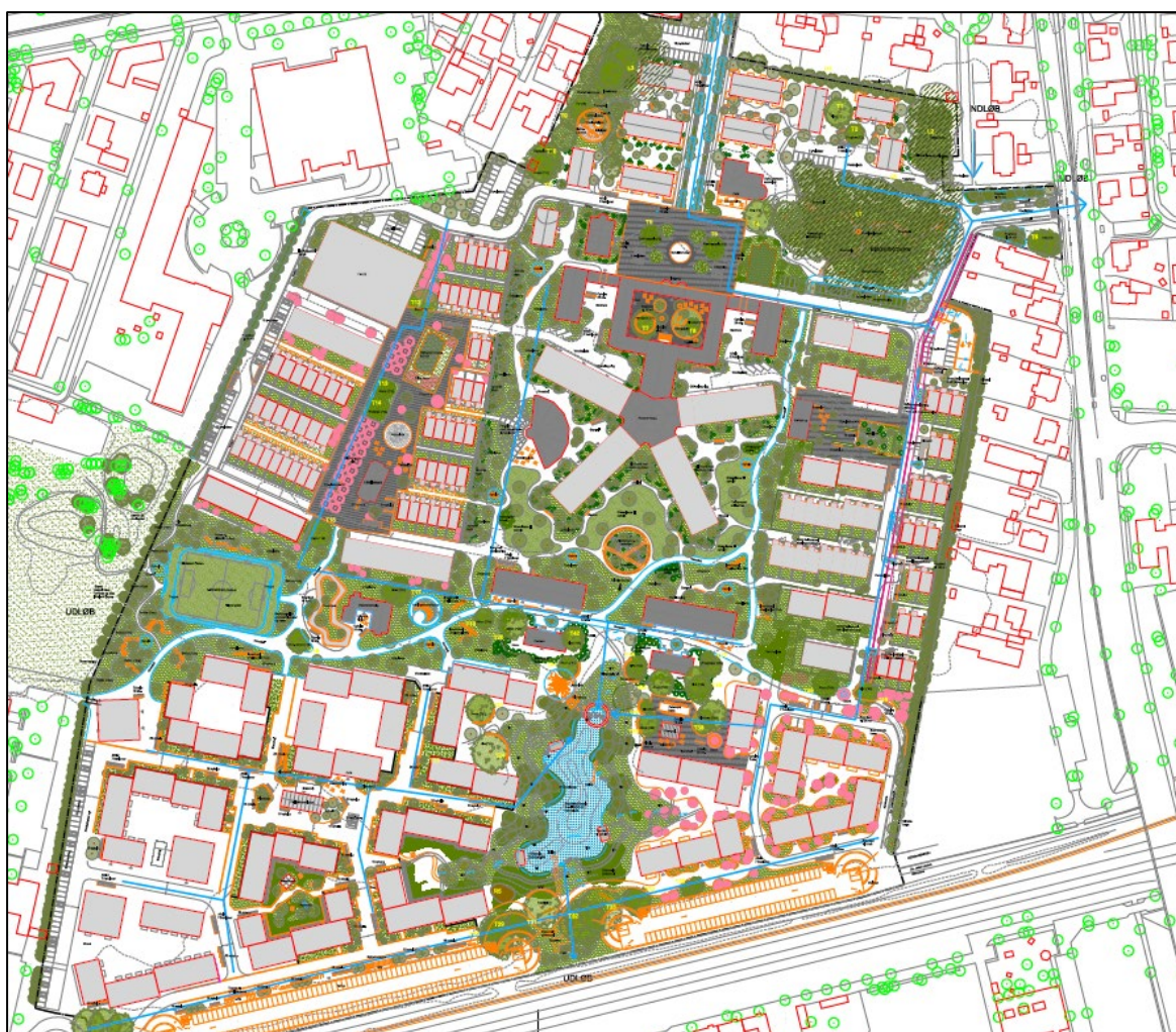
Fig 7-2-3.: Principielle hovedstruktur for det fremtidige regnvandssystem
