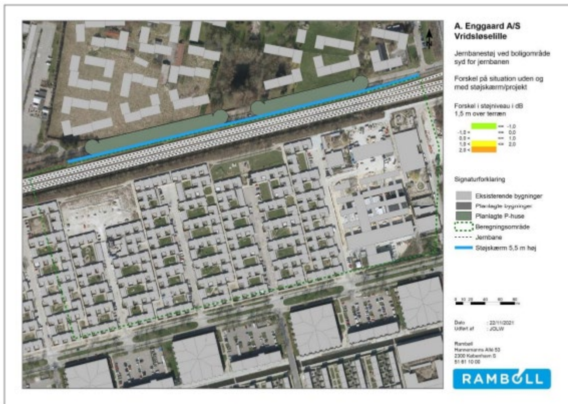
Figur 7-1-15. Illustration af differenskort for jernbanestøjen i boligområdet syd for jernbanen for situationerne uden og med etableret støjskærm.
