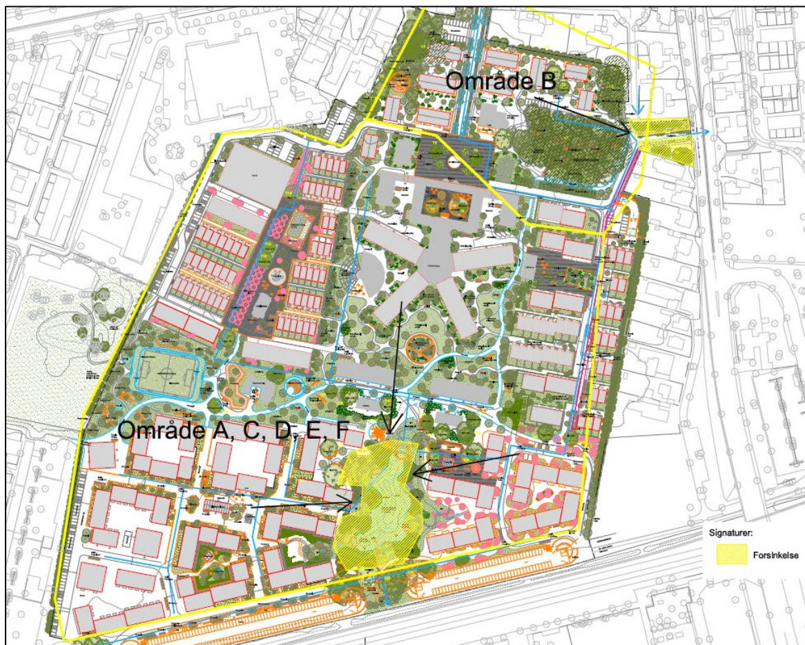
Figur 7-2-2 Oversigt over nye forsinkelsesvolumener. Regnvandet skal forsinkes 2 steder. Område B forsinkes i en lavning imod nordøst, mens alle øvrige områder forsinkes i den planlagte sø. Forsinkelse markeret med gul.
