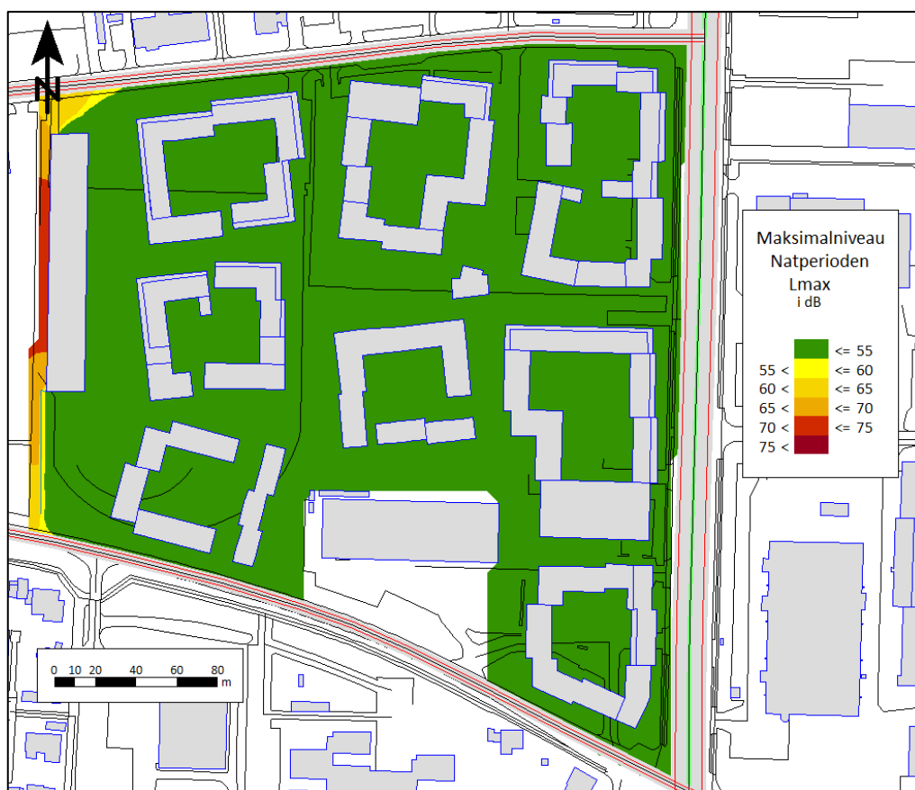
Figur 7-10 Resultat af beregning af maksimalniveau fra UPS på de udendørs opholdsarealer. Beregningshøjde: 1,5 m over terræn.
