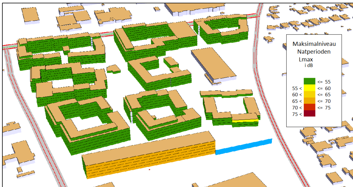
Figur 7-9 Resultat af beregning af maksimalniveau fra UPS på bygningernes facader, set fra vest. Supplerende støjskærm er markeret med blå farve.
