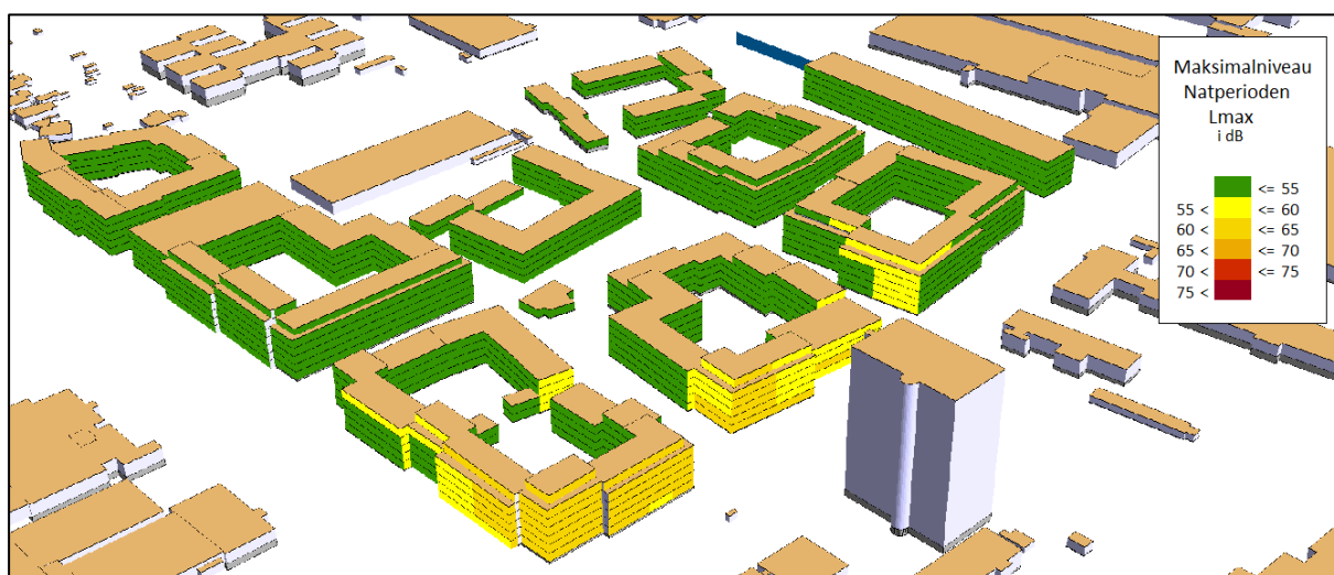
Figur 7-21. Resultat af beregning af maksimalniveau fra Transport 24 på bygningernes facader, set fra nordvest.
