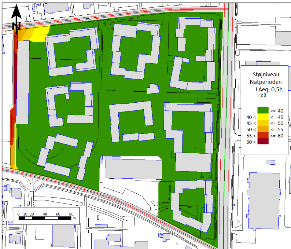
Figur 7-8. Resultat af beregning af støjniveau fra UPS på de udendørs opholdsarealer i natperioden. Beregningshøjde: 1,5 m over terræn.
