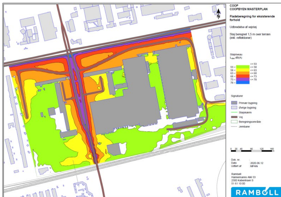
Figur 5-1 Støjvurderingskort for støj fra vejtrafik for eksisterende forhold på Coop-grunden (beregnet 1,5 m. over jorden), Rambøll, juni 2020
