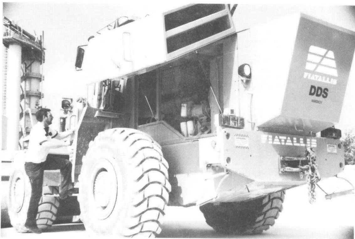
Figur 5.1 Dæmpet gummihjullæsser, HMA Industriakustik [30]
