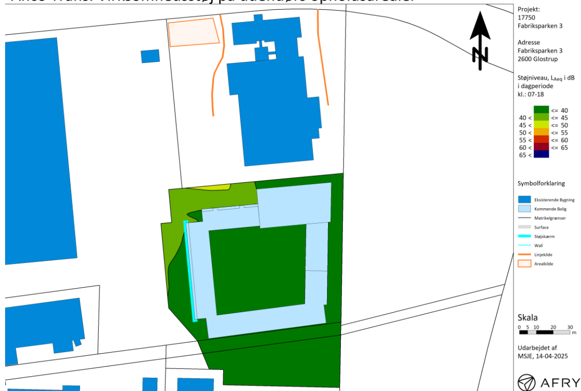
Figur 8.2 Støj fra Anco Trans på udendørs opholdsarealer i dagperiode med et støjniveau op til L_{Aeq} = 50 \text{ dB(A)} på terræn.
