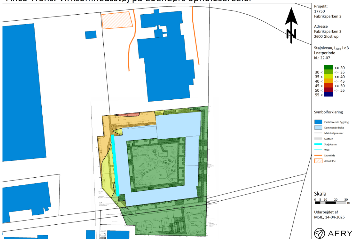
Figur 8.4 Støj fra Anco Trans udendørs i natperiode med et støjniveau op til L_{Aeq} = 40 dB(A) på terræn.
