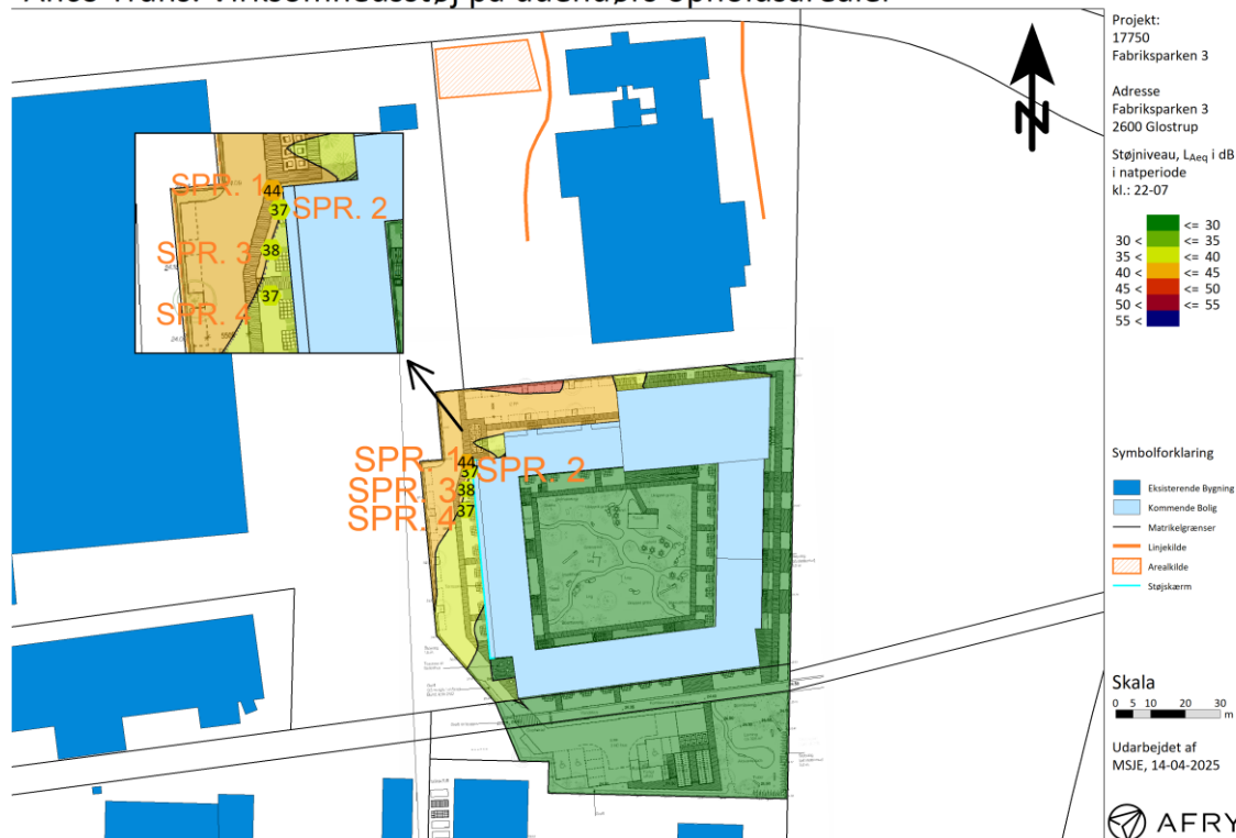
Figur 8.5 Støj fra Anco Trans udendørs i natperiode med et støjniveau op til L_{Aeq} = 38 dB(A) på privat opholdsareal og L_{Aeq} = 44 dB på gangsti.
