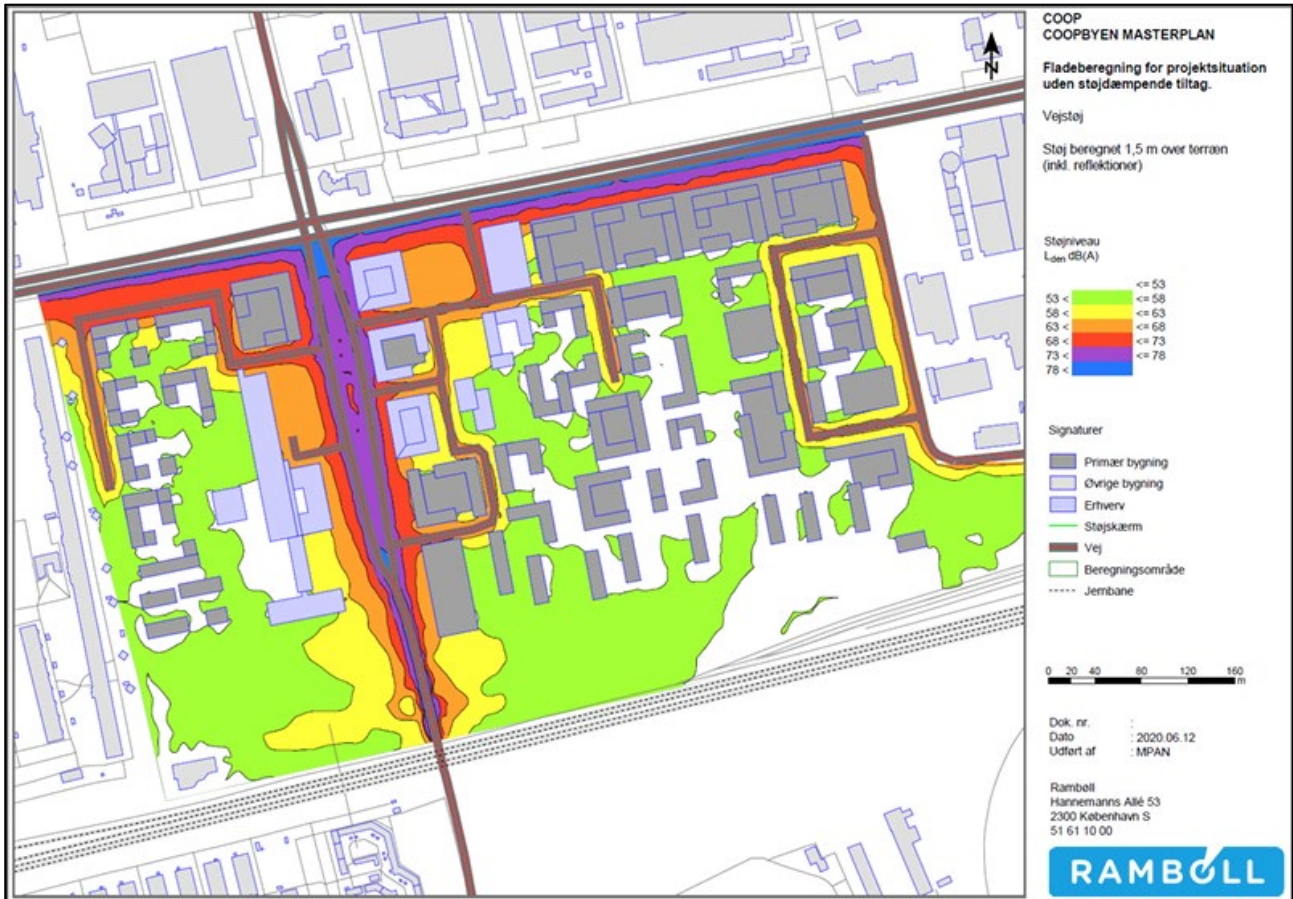
Figur 34: Støjudbredelseskort for vejtrafik for en fremtidig situation, hvor forslag til masterplan realiseres (Rambøll 2020b).
