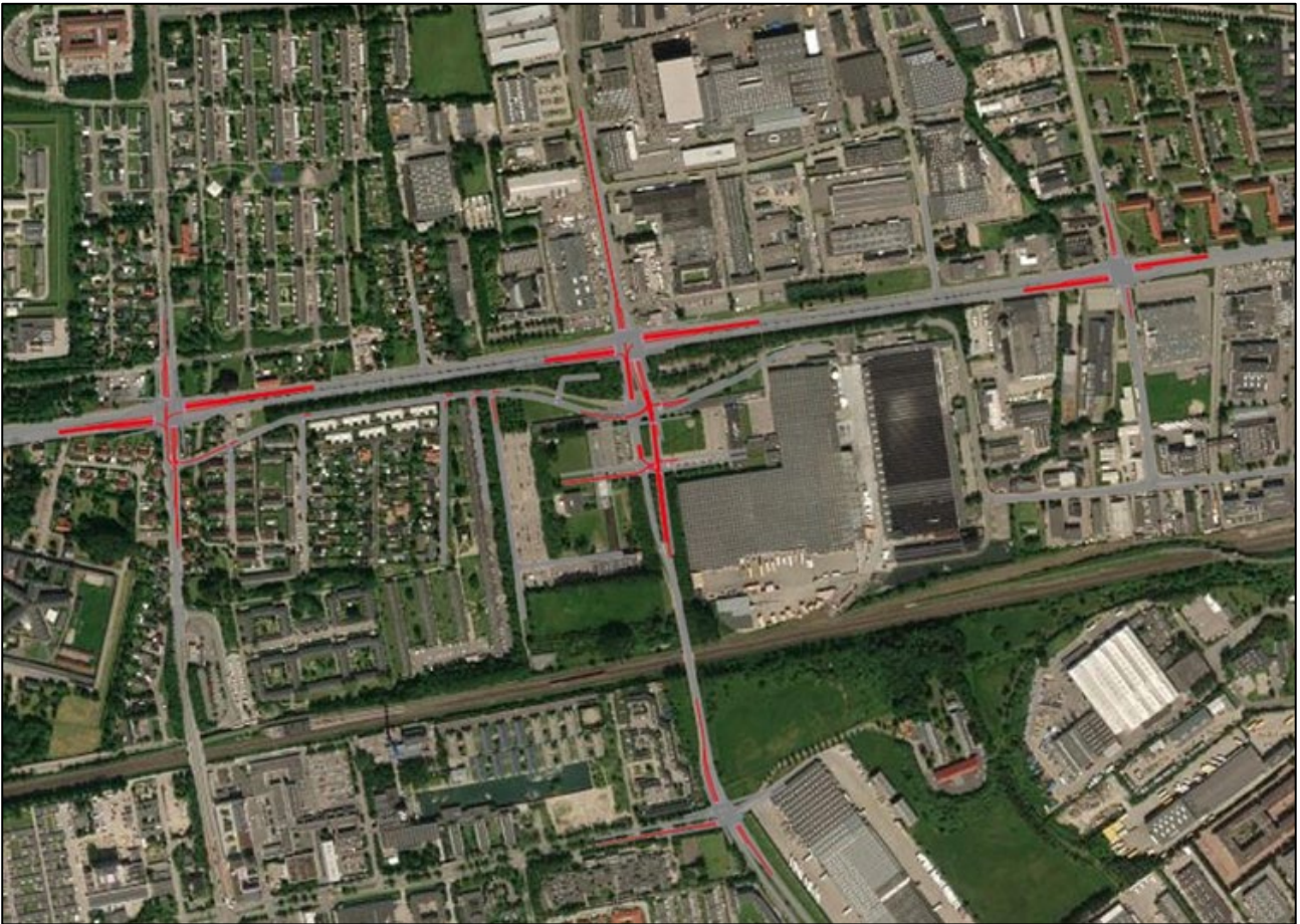
Figur 11: Maksimal kø beregnet for Basis 2019 i eftermiddagsperioden 15:00-17:00. Markeringerne illustrerer den maksimale kølængde udtrykt som 95 % fraktilen (COWI 2021).
