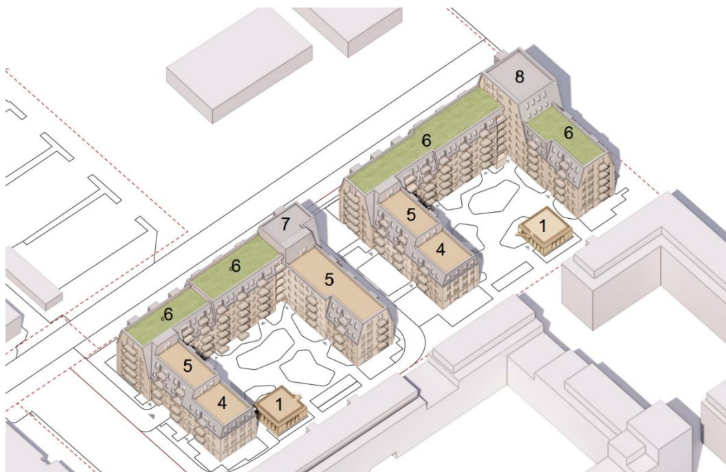
Figur 4.2: 3D figur af byggeriet. Antallet af etager er angivet med sorte tal.
