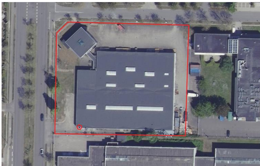
Figur 5.4 Anvendt afkastplacering i OML-beregningerne for virksomheden Snedkerierne A/S. Afkastet er markeret med en rød cirkel. Virksomhedens matrikel er angivet med et rødt polygon.
