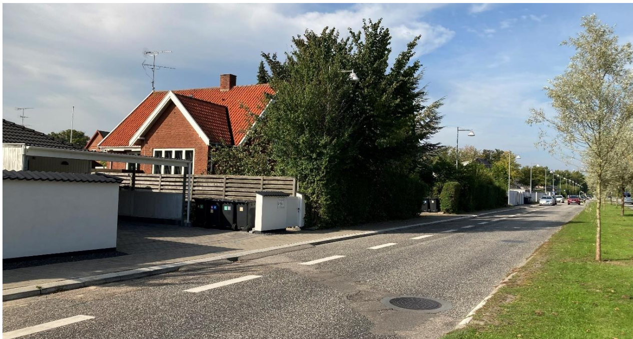
Figur 28. I mange tilfælde kan der ikke plads til en støjskærm langs vejen. Der kan også, som på billedet, være udkørsler fra boligerne, som vil blive blokeret af en støjskærm.
