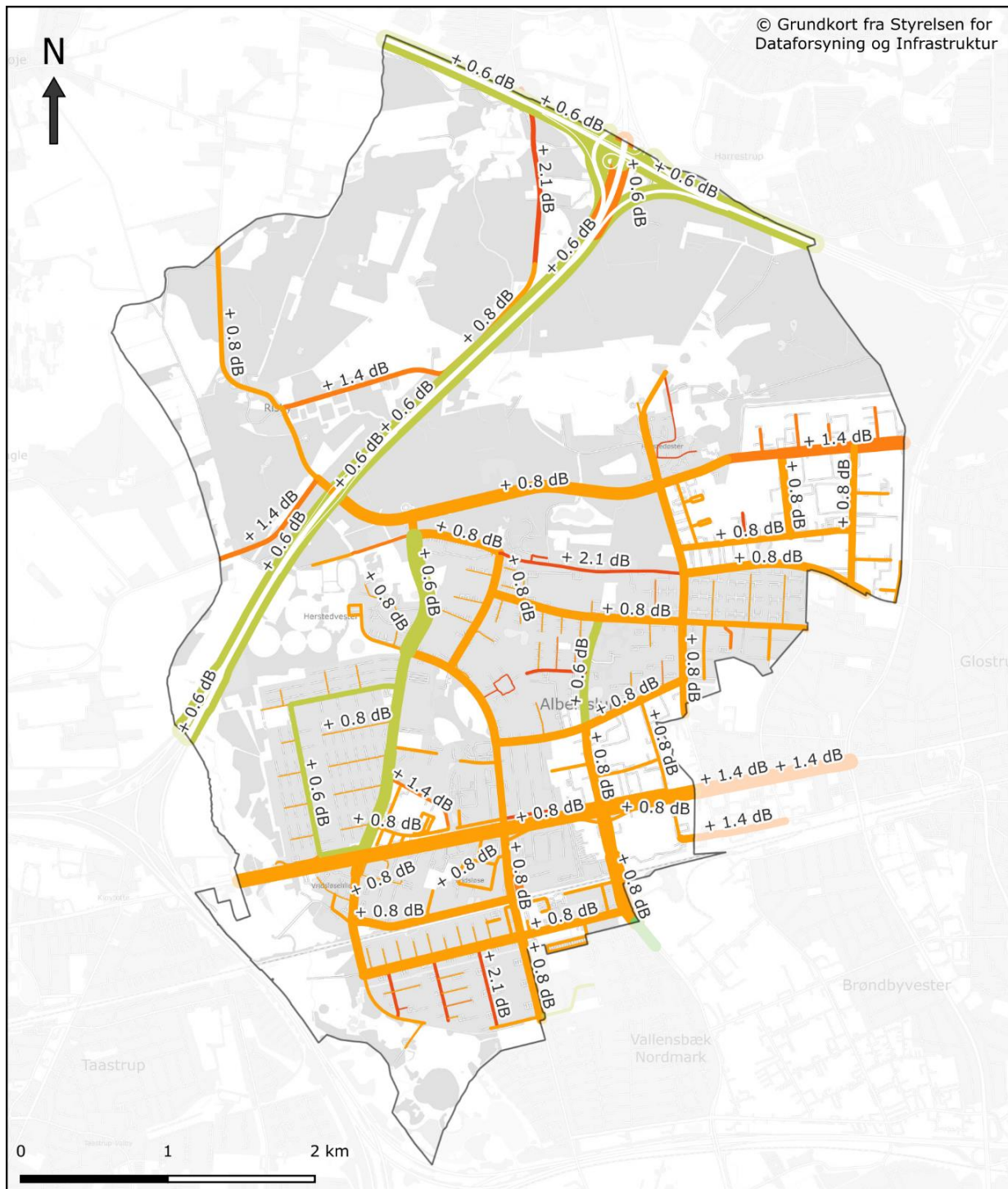
Figur 3. Oversigt over de belægningstyper på kommunens veje og statens, der er forudsat i støjberegningerne. Belægningstyperne SMA 11, OB 11 og brosten er de mest støjende typer. De øvrige er mindre støjende vejbelægninger.
