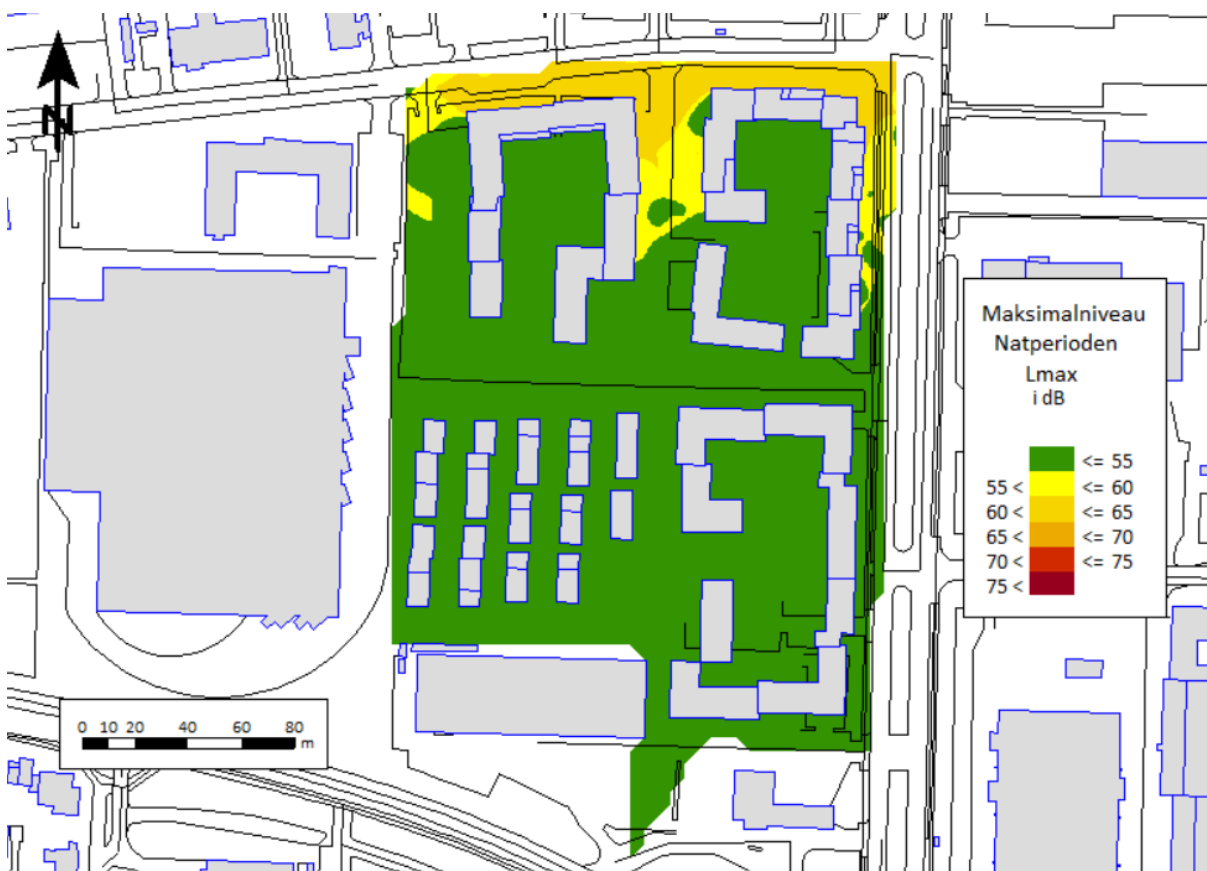
Figur 20: Resultat af beregning af maksimalniveau fra Transport 24 på de udendørs opholdsarealer. Beregningshøjde: 1,5 m over terræn.
