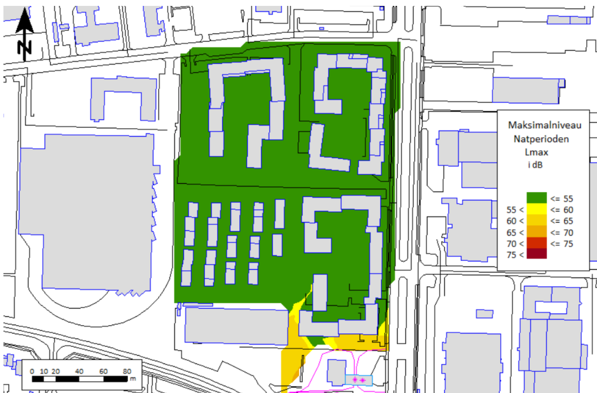
Figur 24: Resultat af beregning af maksimalniveau fra Ingo på de udendørs opholdsarealer. Beregningshøjde: 1,5 m over terræn.
