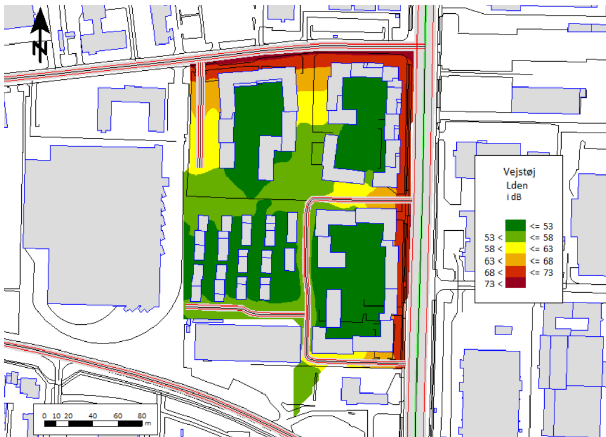
Figur 1: Resultat af beregning af vejstøj 1,5 m over terræn. Beregning inkl. bygninger fra illustrationsplanen.
