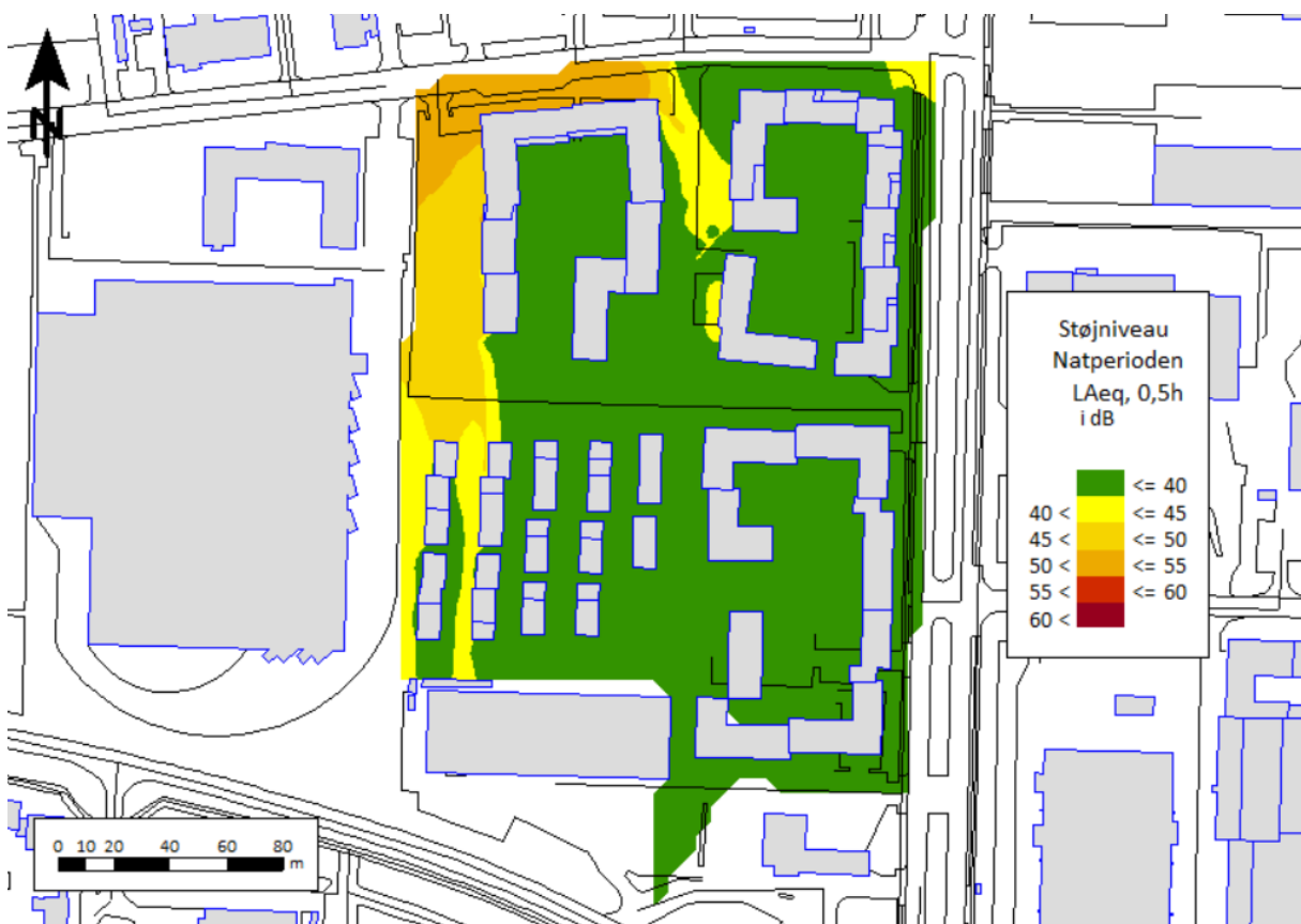
Figur 10: Resultat af beregning af støjniveau fra Sparta Cph ApS på de udendørs opholdsarealer i natperioden. Beregningshøjde: 1,5 m over terræn.
