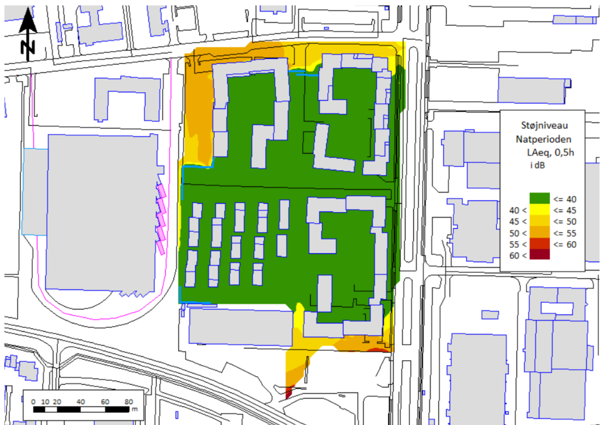
Figur 30: Samlet oversigt, støj fra virksomheder. Beregning af støjniveauer på udendørs opholdsarealer i natperioden. Beregningshøjde 1,5 m over terræn. Figuren viser det højeste støjniveau fra de omkringliggende virksomheder. Beregning inkl. afskærmende tiltag
