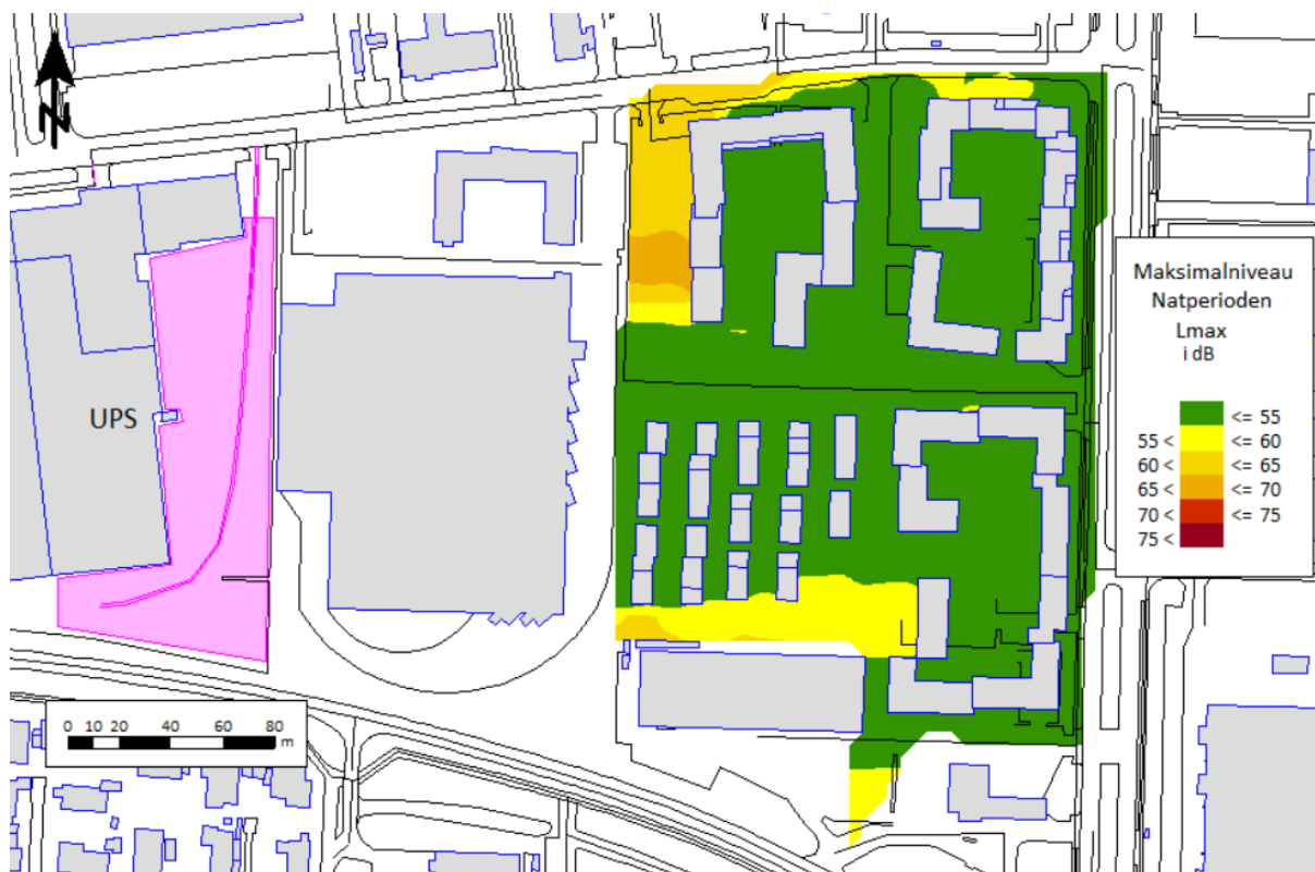
Figur 8: Resultat af beregning af maksimalniveau fra UPS på de udendørs opholdsarealer. Beregningshøjde: 1,5 m over terræn.
