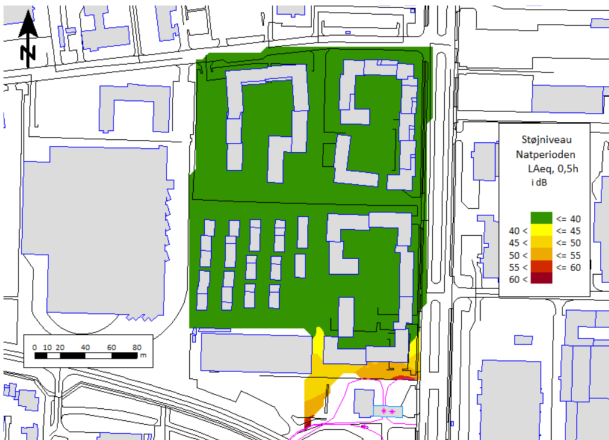
Figur 22: Resultat af beregning af støjniveau fra Ingo på de udendørs opholdsarealer. Beregningshøjde: 1,5 m over terræn.
