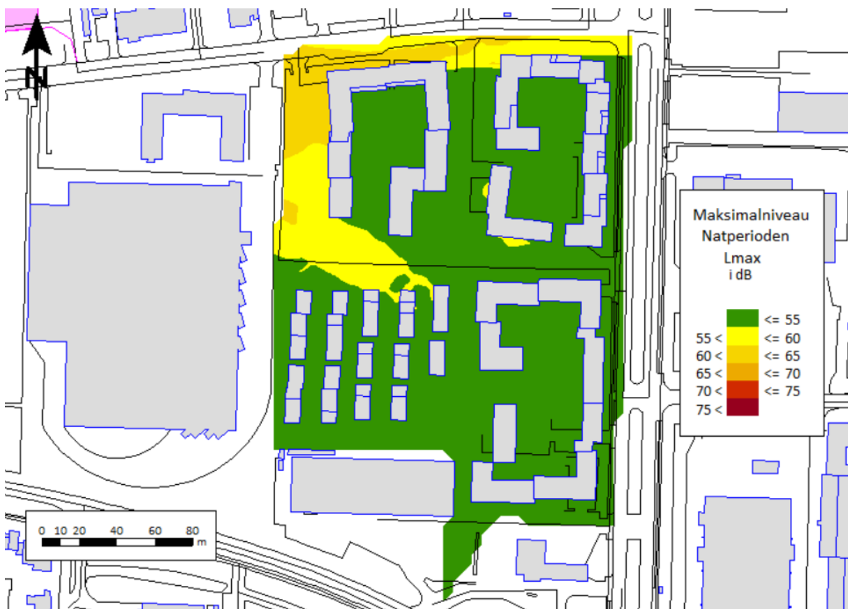
Figur 12: Resultat af beregning af maksimalniveau fra Sparta Cph ApS på de udendørs opholdsarealer. Beregningshøjde: 1,5 m over terræn.
