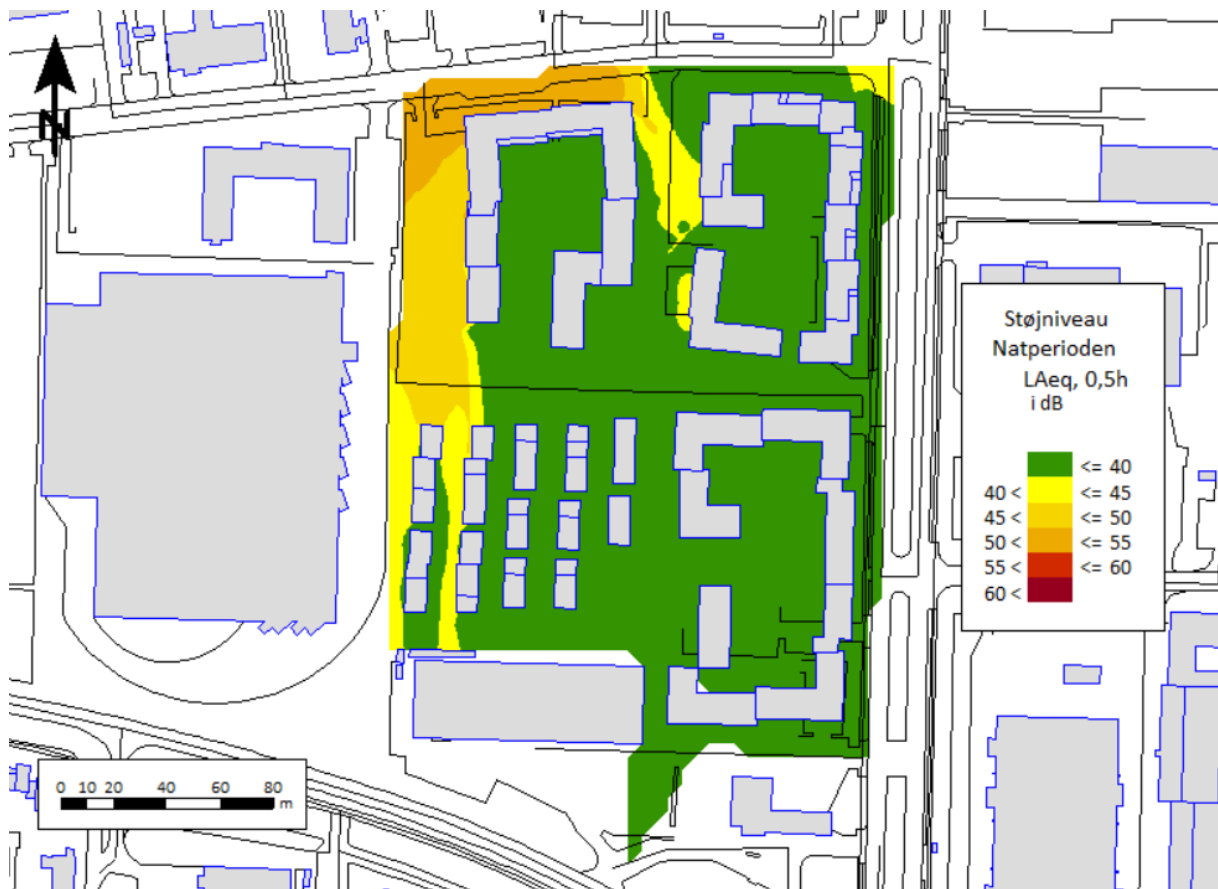
Figur 14: Resultat af beregning af støjniveau fra Smedeland 9 på de udendørs opholdsarealer i natperioden. Beregningshøjde: 1,5 m over terræn.
