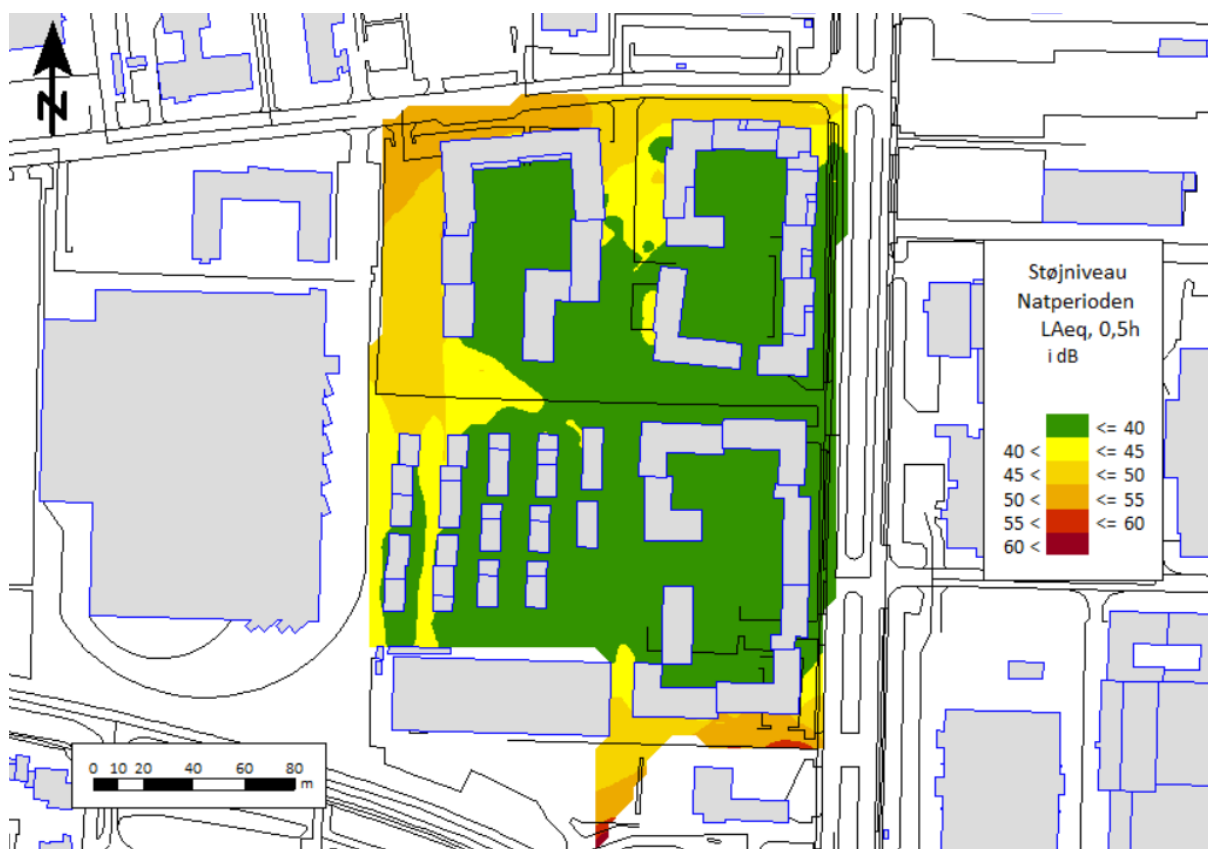
Figur 27: Samlet oversigt, støj fra virksomheder. Beregning af støjniveauer på udendørs opholdsarealer i natperioden. Beregningshøjde 1,5 m over terræn. Figuren viser det højeste støjniveau fra de omkringliggende virksomheder.
