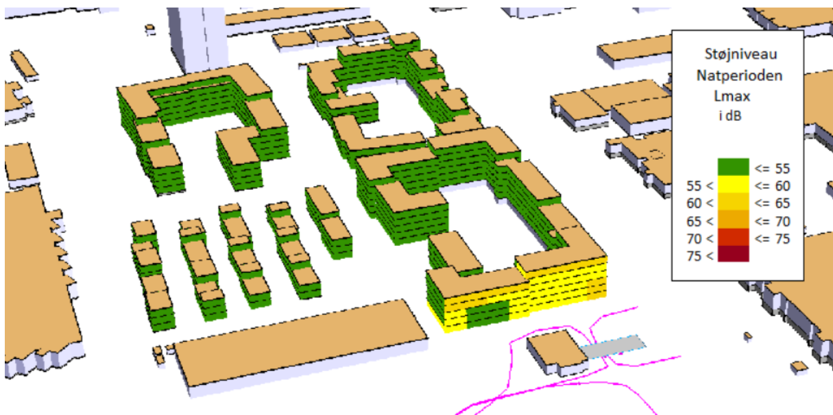
Figur 23: Resultat af beregning af maksimalniveau fra Ingo på bygningernes facader, set fra Syd.
