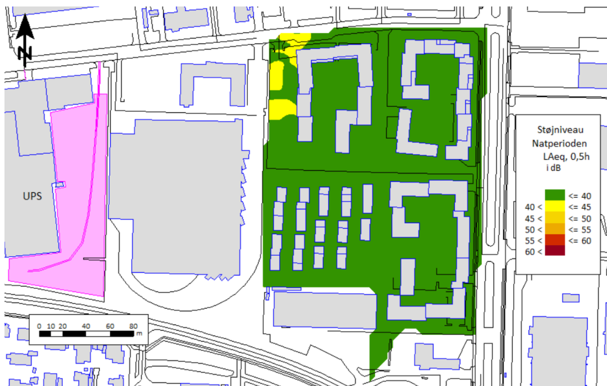
Figur 6: Resultat af beregning af støjniveau fra UPS på de udendørs opholdsarealer i natperioden. Beregningshøjde: 1,5 m over terræn.
