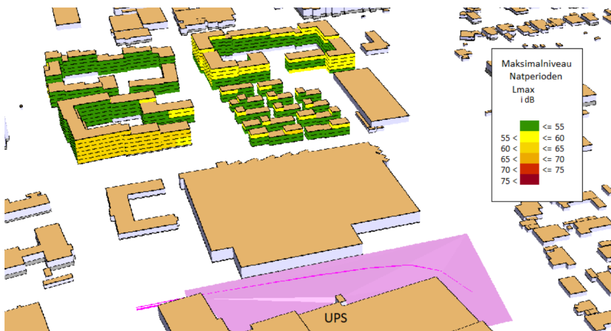
Figur 7: Resultat af beregning af maksimalniveau fra UPS på bygningernes facader, set fra vest.
