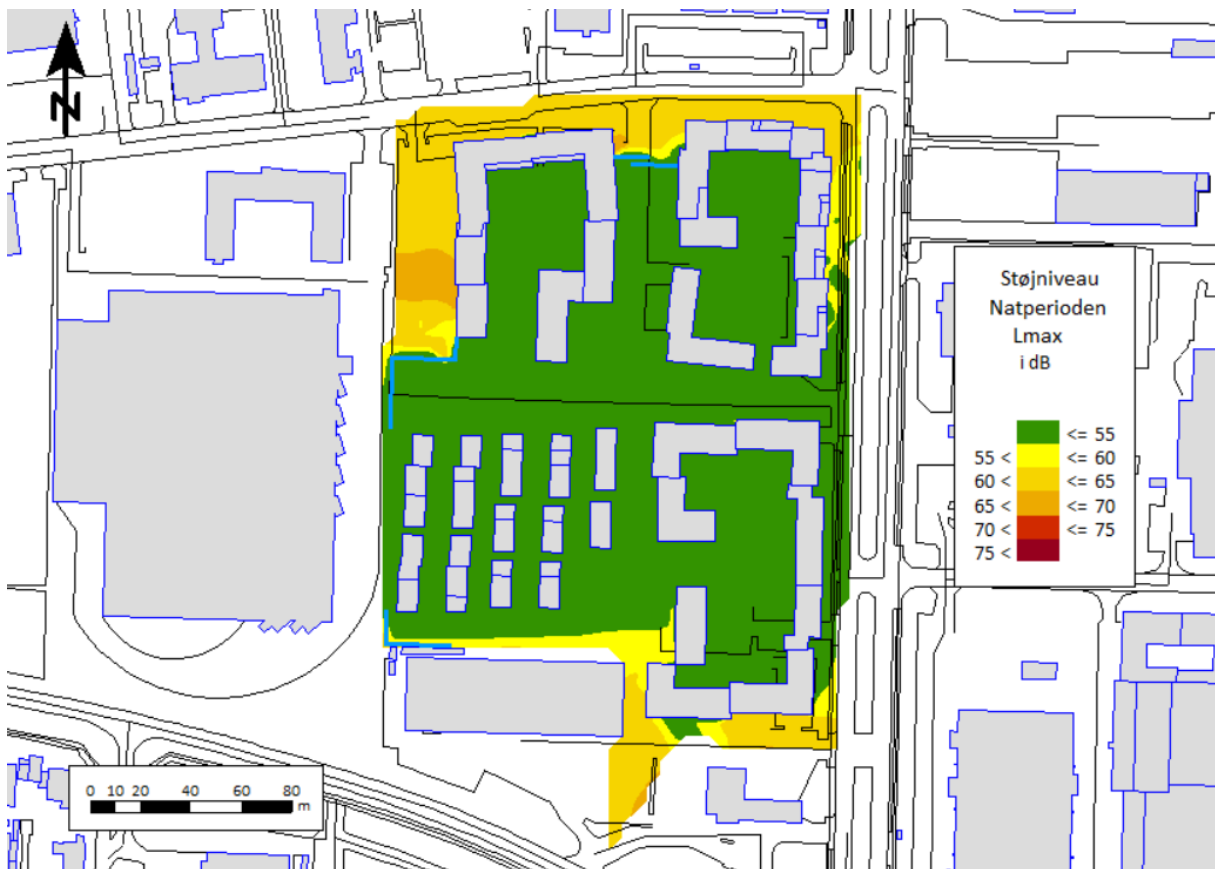
Figur 33: Samlet oversigt. Beregning af maksimalniveauer på udendørs opholdsarealer i natperioden. Beregningshøjde 1,5 m over terræn. Figuren viser det højeste maksimalniveau fra de omkringliggende virksomheder. Beregning inkl. afskærmende tiltag.
