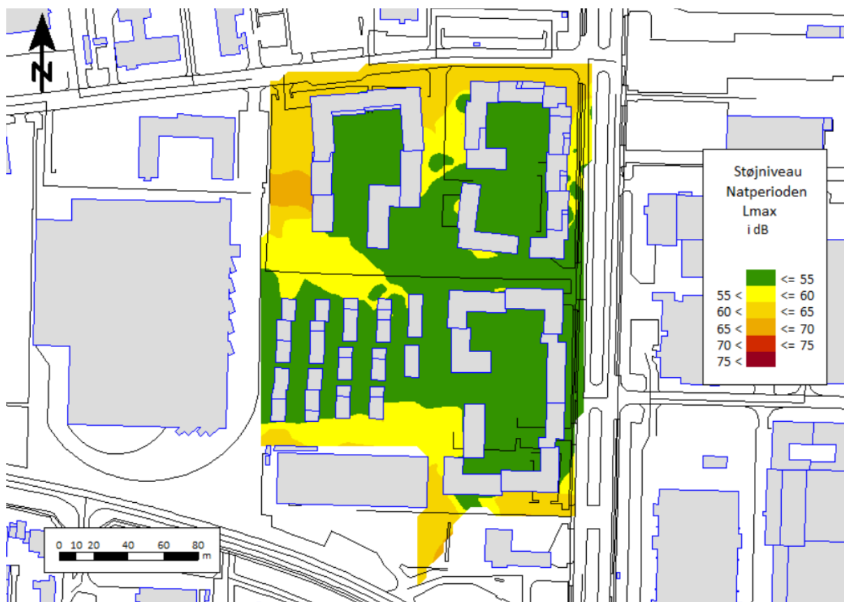
Figur 28: Samlet oversigt. Beregning af maksimalniveauer på udendørs opholdsarealer i natperioden. Beregningshøjde 1,5 m over terræn. Figuren viser det højeste maksimalniveau fra de omkringliggende virksomheder.
