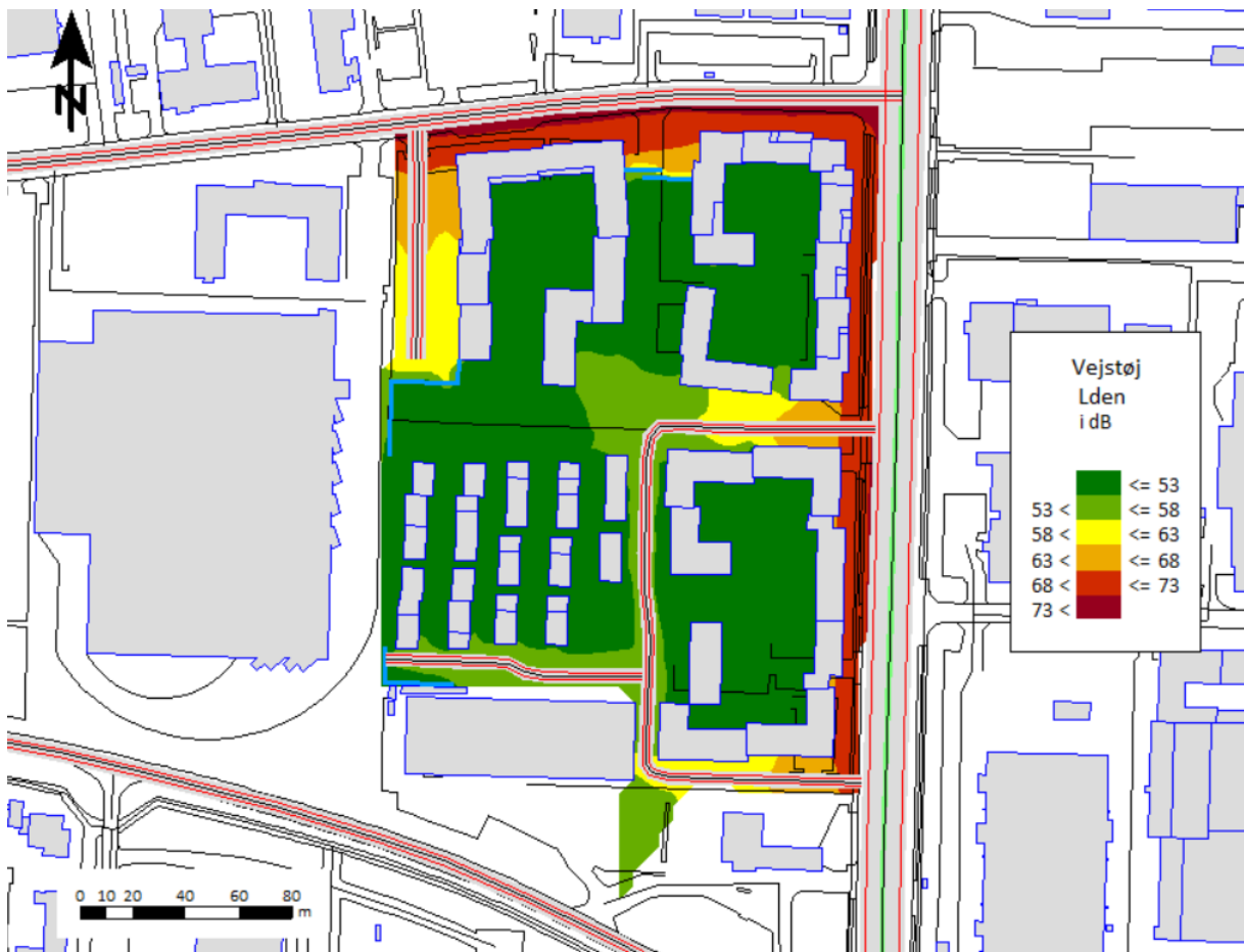
Figur 36: Resultat af beregning af vejstøj på udendørs opholdsarealer, inkl. støjafskærmende tiltag. Beregningshøjde 1,5 m over terræn.
