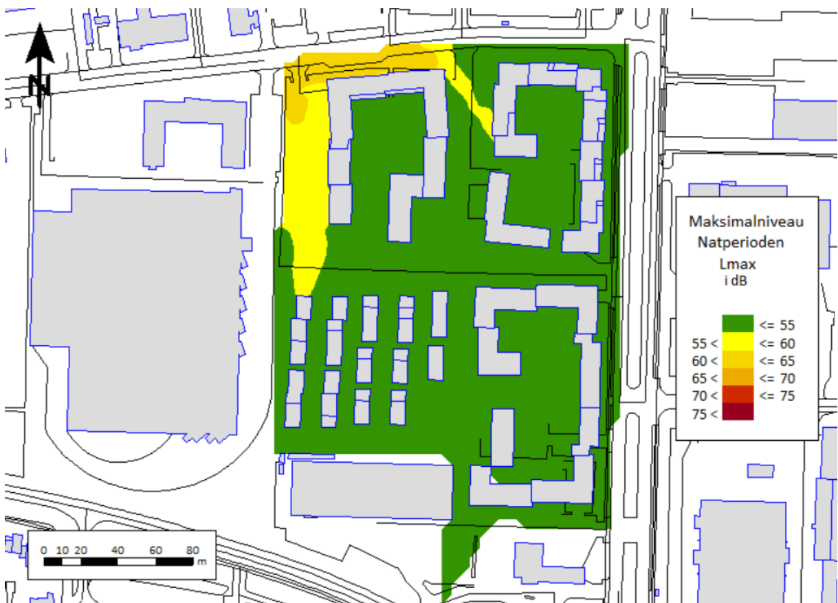
Figur 16: Resultat af beregning af maksimalniveau fra Smedeland 9 på de udendørs opholdsarealer. Beregningshøjde: 1,5 m over terræn.
