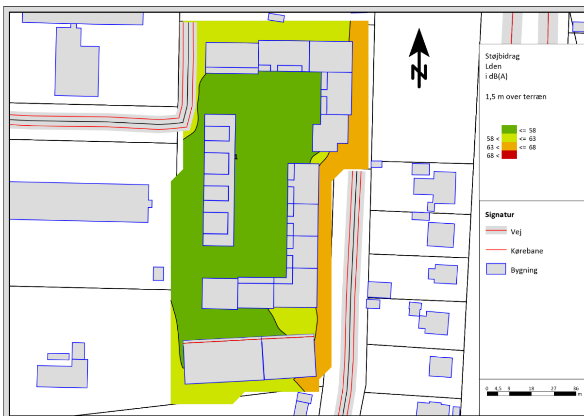
Figur 9.2: Støjudbredelseskort for planområdet. Kortet viser de beregnede støjbidrag fra den forventede vejtrafik i 2030 i højden 1,5 m over terrænet.
