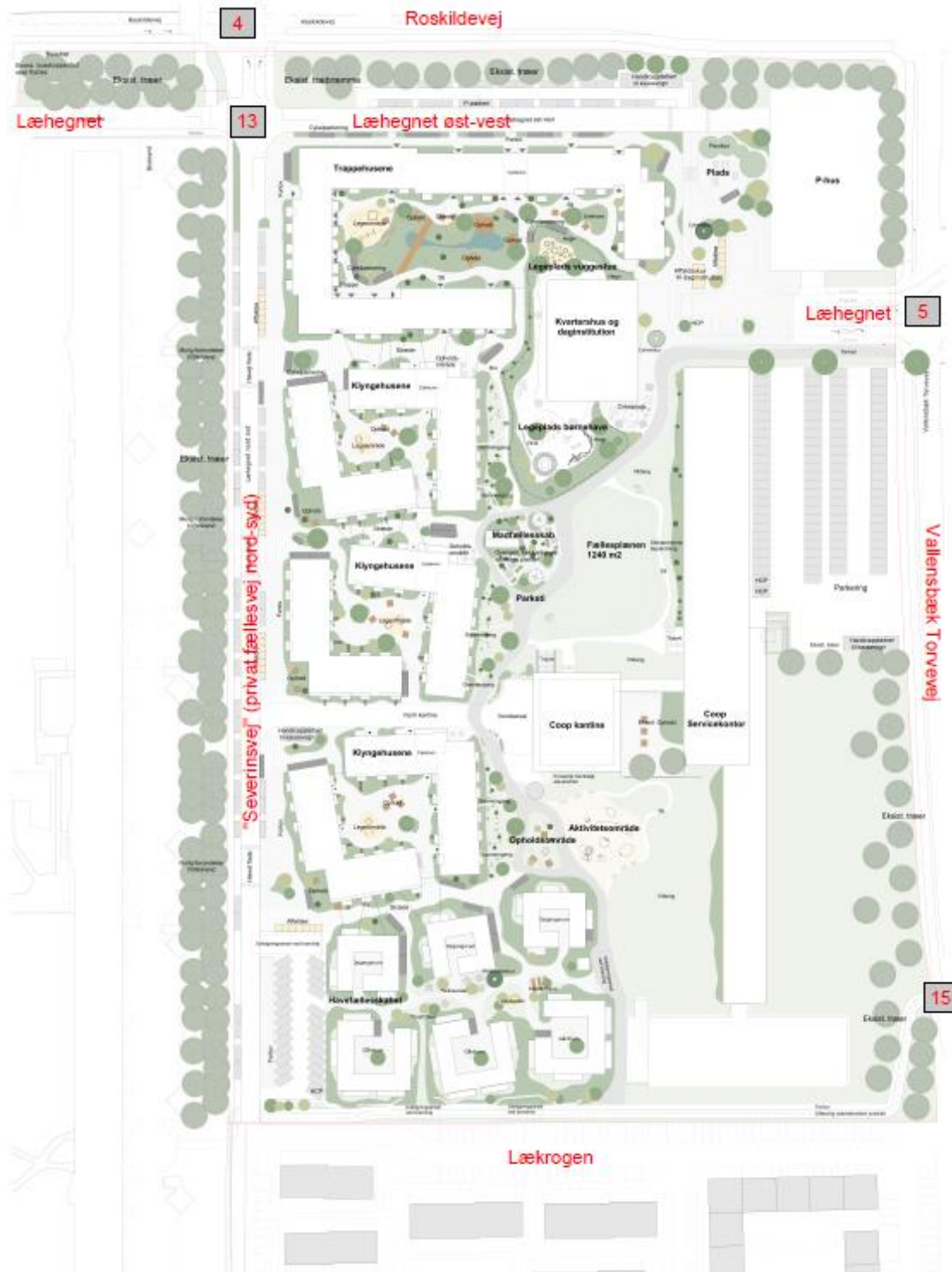
Figur 1-1 Illustrationsplan for fase 1 af COOP-byen med foreslåede adgangsforhold. (Nummereringer på kortet henviser til respektive krydsnumre – se nedenunder og figur 1-2).
