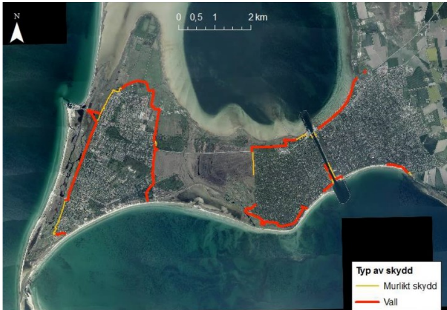
Figur 10.1 Projekt Skyddsvallen på Falsterbo. Rød linje viser det planlagte digeforløb (16 km) og gul viser højvandsmur (5 km). Kilde: Växjö Tingsrätt (2020).
