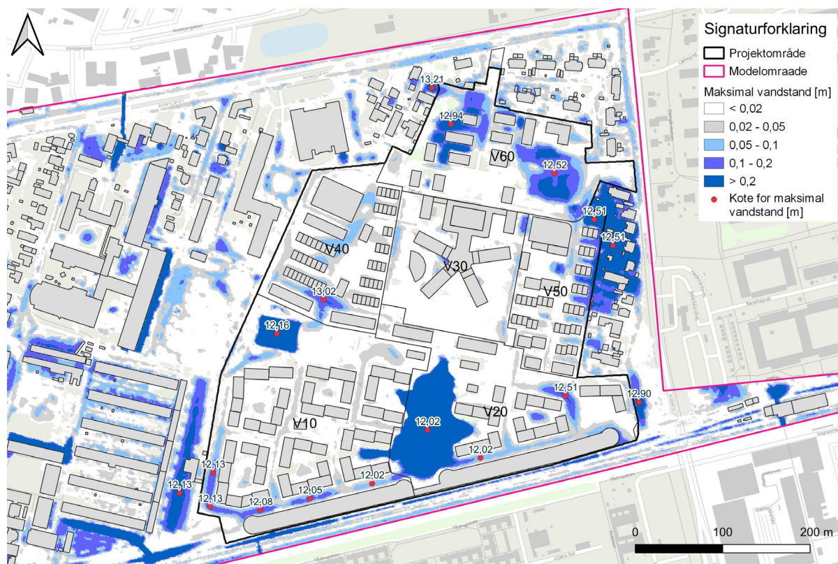
Figur 3.5 Maksimal vanddybde samt vandstandskote i projektområdet ved fremtidige forhold ved en 100-årshændelse om 100 år.
