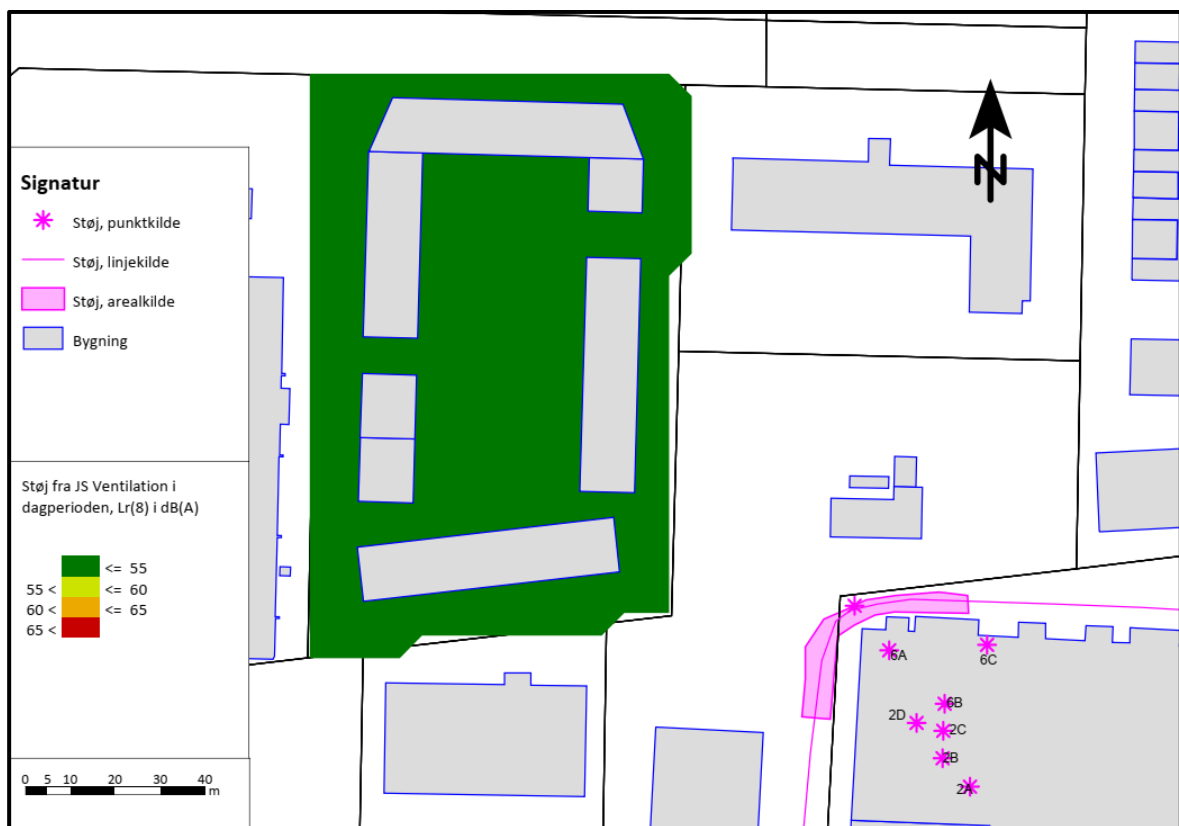
Figur 6.6: JS Ventilations støjbidrag på det udendørs opholdsareal.
