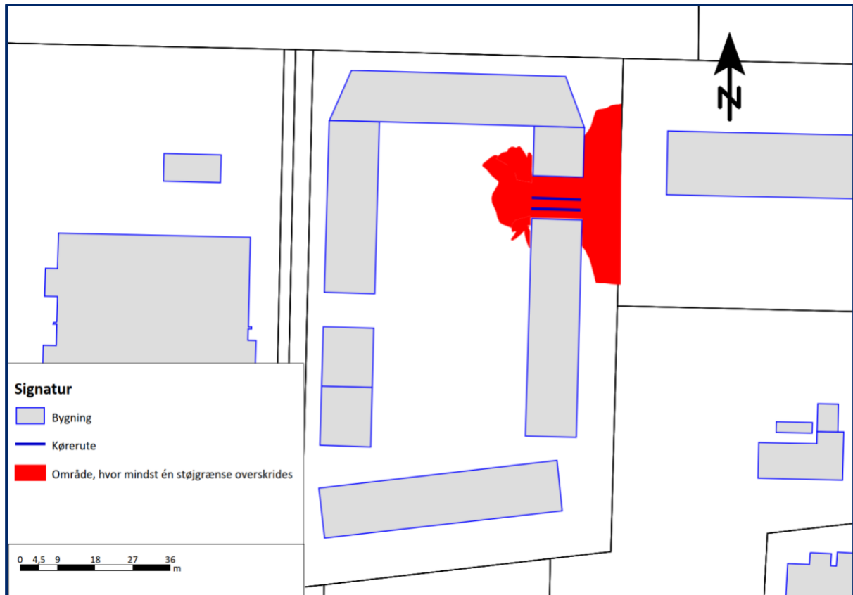
Figur 6.46: Støj fra bilkørsel til og fra p-kælder.
