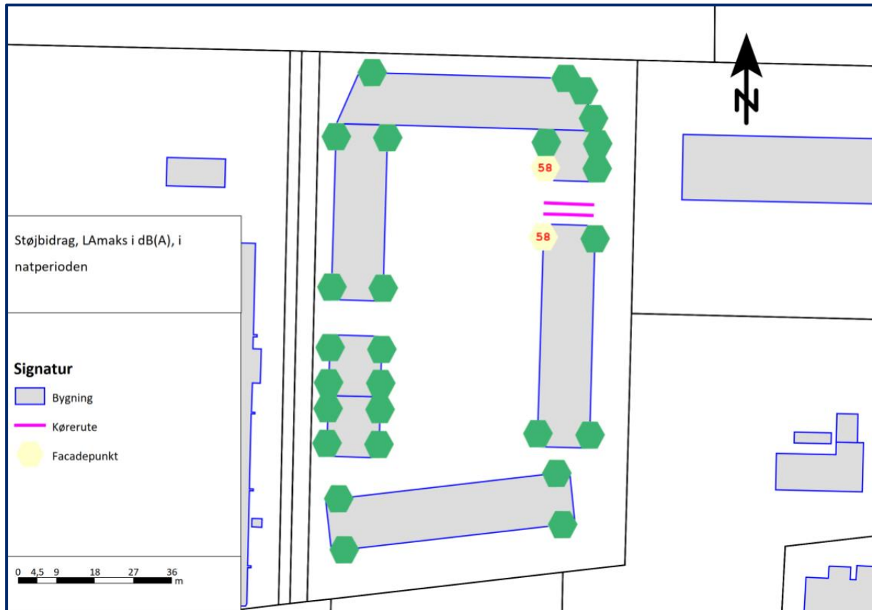
Figur 6.48: Beregnede støjbidrag, LAmaks i dB(A), fra kørsel til og fra p-kælderen. Grænseværdien på 55 dB(A) er overholdt i de grønne facadepunkter. I de gule facadepunkter er grænseværdien overskredet og de beregnede støjbidrag i dB(A) er angivet med rødt.
