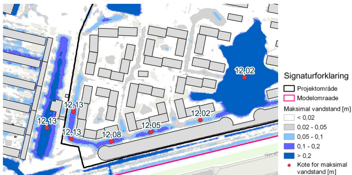
Figur 8. Diagram fra Mike Flood som viser maksimal vanddybde samt vandstandskote i Karrékvarteret, V10, ved en 100-årshændelse om 100 år.
