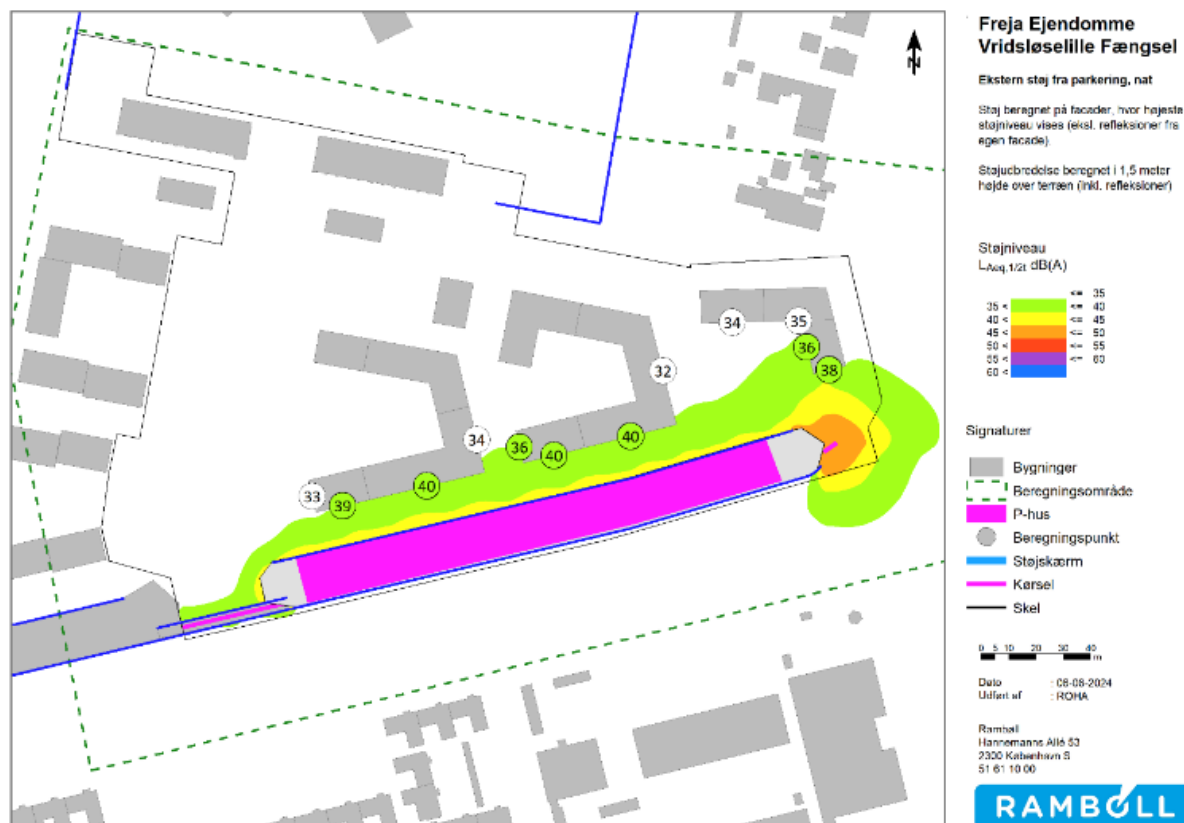
Figur 17: Beregnet støjubredelse 1,5 meter over terræn og støjniveau på bolig-facader for natperioden. Beregningerne er foretaget af Rambøll
