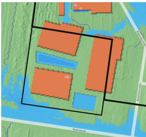
Figur 8.1: Løsningsforslag med nedsænkning af ophold og cykelparkeringsområde, modelleret med 50 mm regn i Scalgo /1//14/.
