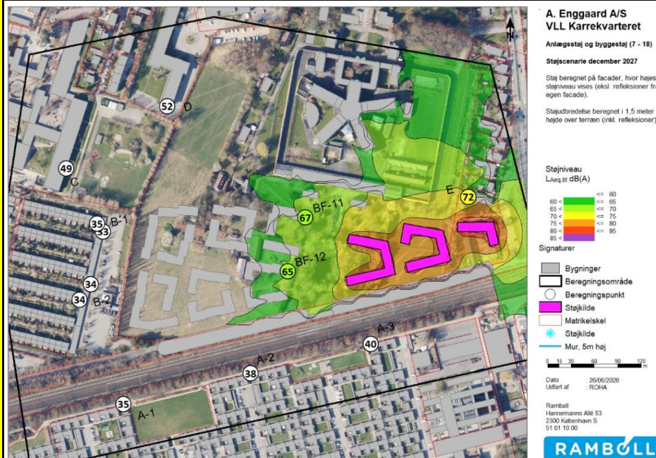
Figur 12 - Støj på facader og støjudbredelse for scenarie nr. 4 i december 2027, hvor alle bygninger i V10 samt enkelte i V20 er klar til ibrugtagelse, mens der stadig er byggeaktivitet i en del af område V20. Støjniveauer i cirkler er beregnet på facaden af bygninger, hvor det højeste støjniveau vises. Støjniveauet er beregnet som en worst-case situation.
