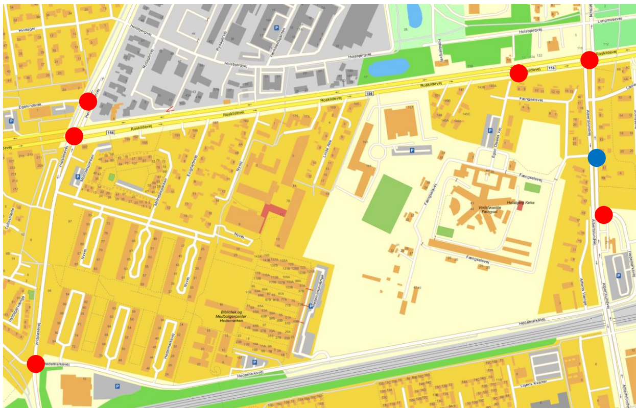
Figur 2. Oversigt over adgangsveje og trafiksignaler i simuleringsmodellen. Røde felter er trafiksignaler, blå er planlagte vigepligtsregulerede adgangsveje.
