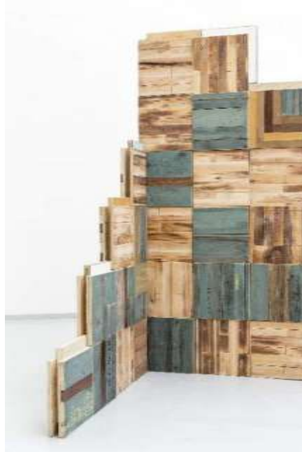
Moduler fra Genbyg. Størrelsen er 50 x 50 cm og de er produceret af fx døre og gulve der er skåret til og sat op på krydsfinérplader så modulerne nemt monteres på væggen.
