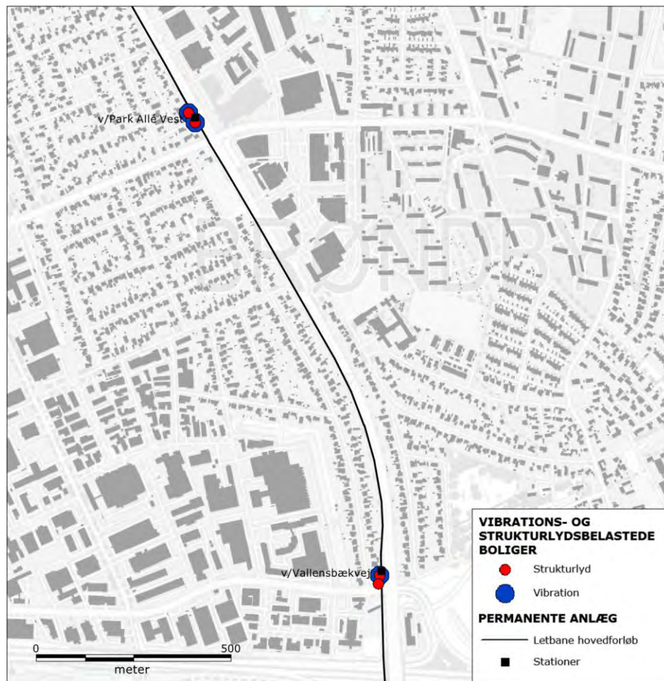
Figur 9-4 | Vibrations- og strukturlydsbelastede boliger langs Søndre Ringvej i Brøndby Kommune.
