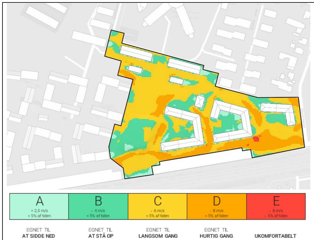
Figur 6-16 Lawson LDDC vindkomfortkategorisering 1,75 m over terræn, baseret på årlig vindstatistik. Bilag 6 Mikroklima-rapport Delområde D – Hængslet
