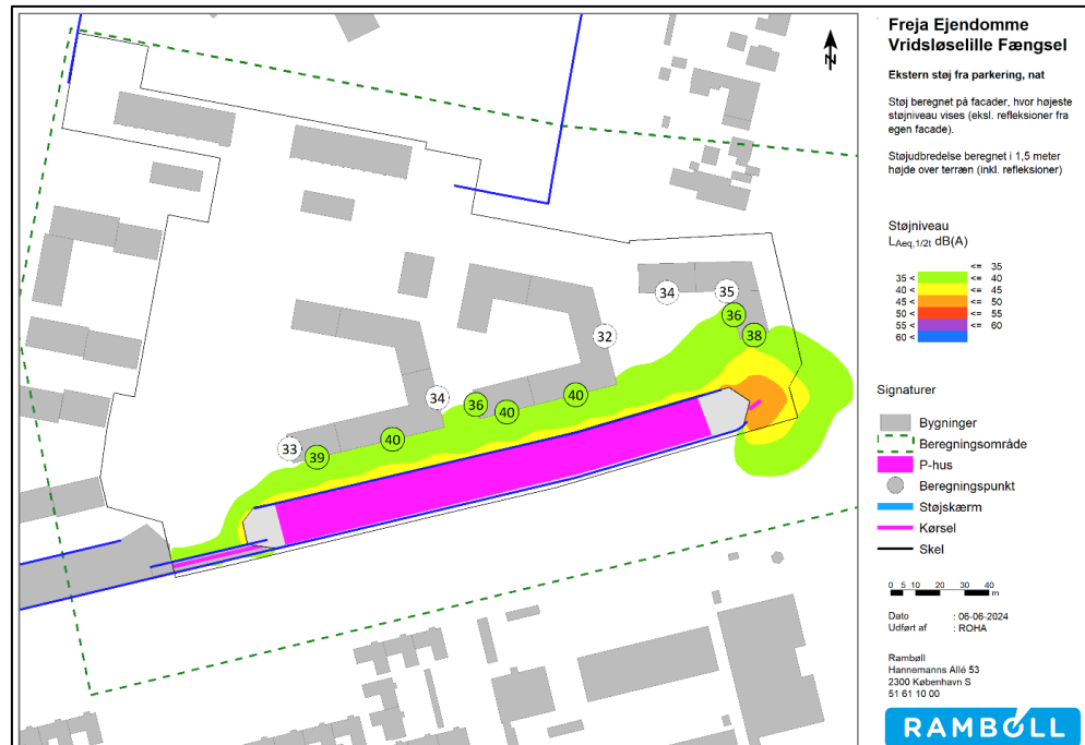
Figur 6-13 Beregnet støjudbredelse 1,5 meter over terræn og støjniveau på boligfacader for natperioden. Se Bilag 3 Undersøgelse af støj fra parkeringshuse
