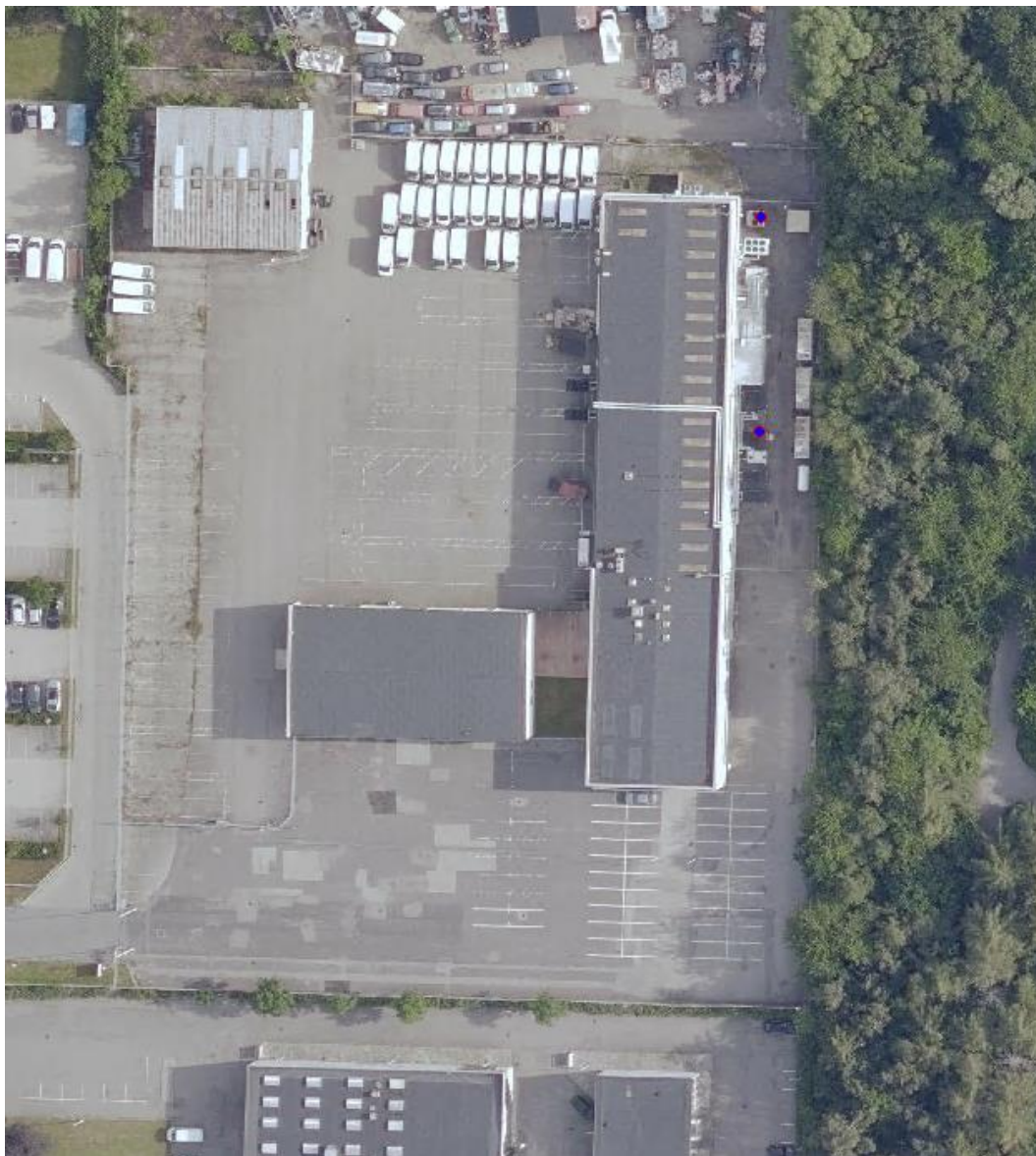
Figur 9.1 Luftfoto af Sentia. Ventilationsanlæg medtaget i beregning er markeret med blå prik. S10 er den sydligste prik.
