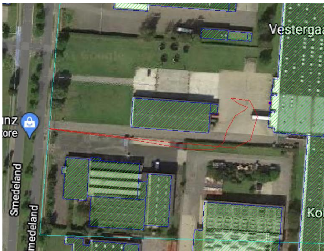
Figur 9.11 Støjkloder ved Skanlog vestporte. Vareaflysning ved port medtaget i beregning er markeret med blå prik. Kørsel med lastbil er markeret med rød linje.
