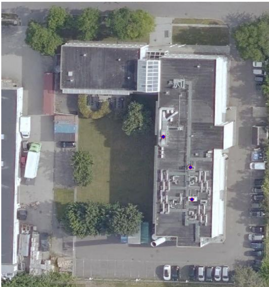
Figur 9.3 Luftfoto af Saniona. Ventilationsanlæg medtaget i beregning er markeret med blå prik.
