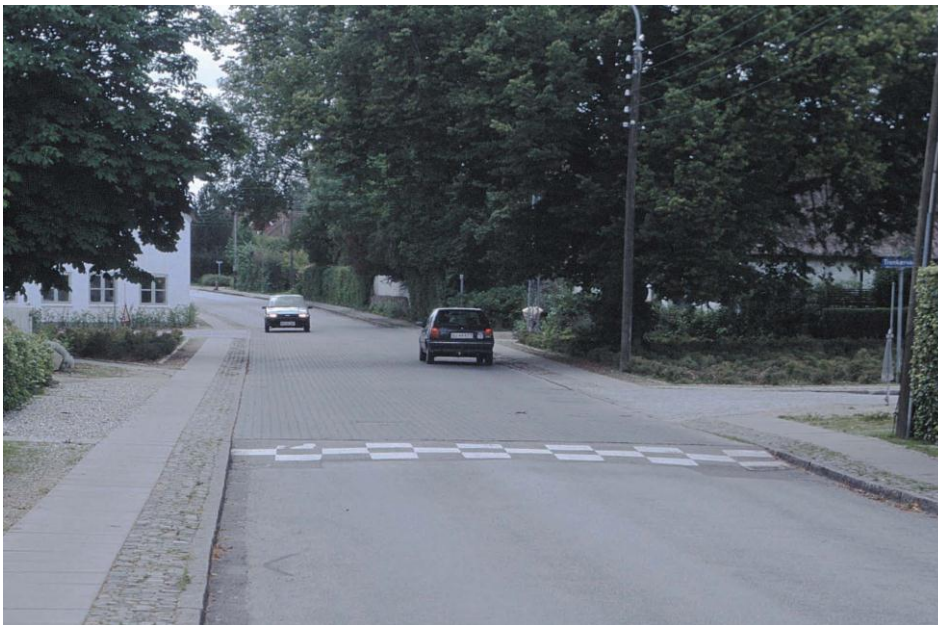
Figur 4.25 Hævet kørebaneflade med ramper
