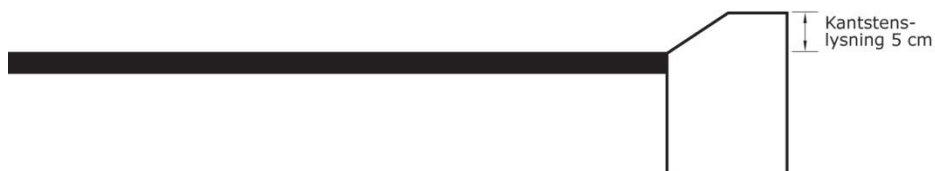
Figur 4.26 Affaset kantsten med angivelse af kantstenslysning
