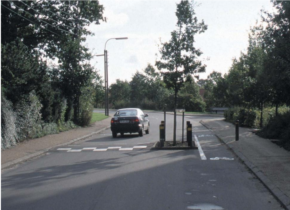
Figur 4.45 Steler, som signal og som spærring. Stelerne bør være eftergivelige.
