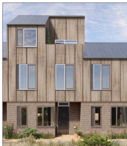
Figur 19: Eksempel på bebyggelsens facade mod det fælles ankomstareal og hvordan bebyggelsen kan udformes med en opdeling af facadens base og midte/tag. Beklædningen på midten er en træbeklædning, som har en vertikal profilering.
