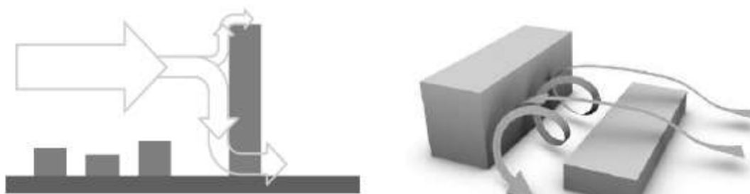
Principskitse: Således fanger høje bygninger vinden og dirigerer den ned i terræn.
