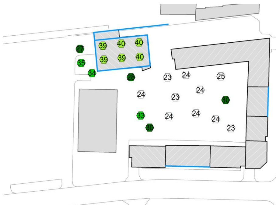
Figur 9: Støj i natperioden fra Snekkerierne. Støjbelastning vist som L_{Aeq,1st} i dB på udendørs opholdsarealer.
