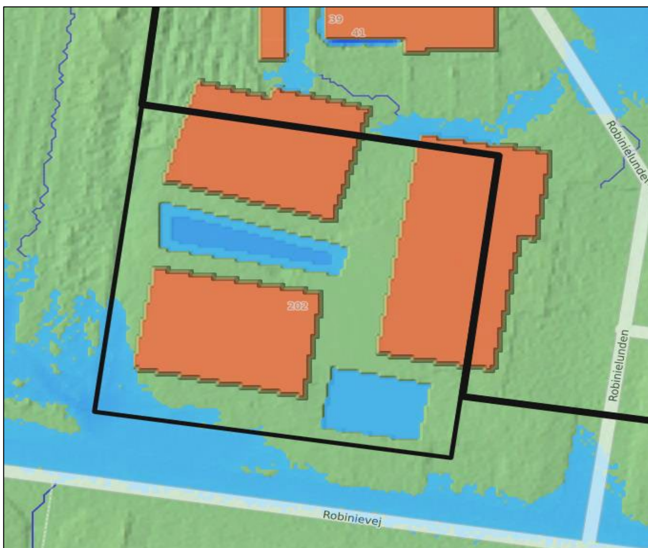
Udsnit fra Vandhåndteringsplanen med foreslåede forsinkelsesbassiner på delområde 2, der består af en 'fordybning' i opholdsområdet mellem bygningerne på 36,75 m 3 , og en 'fordybning' ved cykelparkeringsområdet tættest på Robinievej på 19,5 m 3 . Disse fordybninger vil kun være helt eller delvist vandfyldte ved ekstremhændelser.
