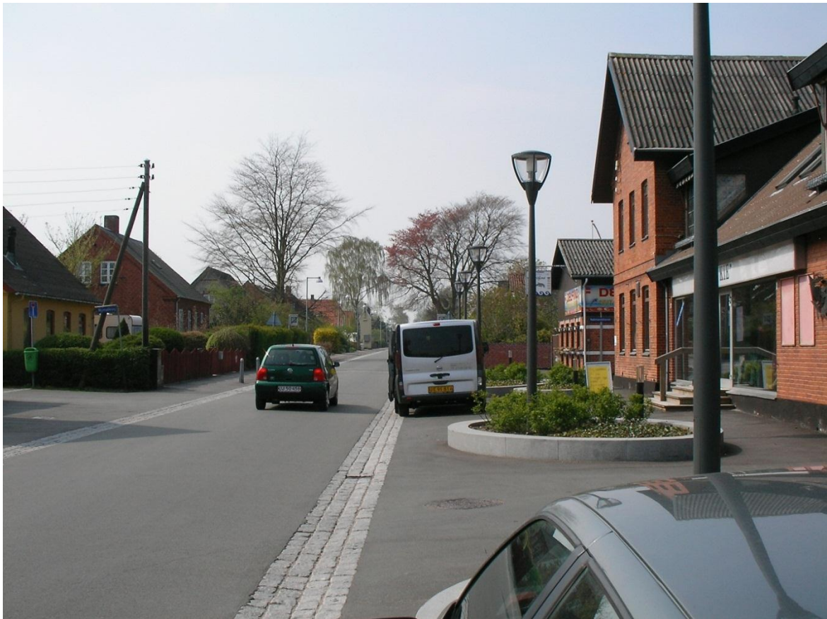
Figur 5.6 Eksempel på gade, hvor asfalt er benyttet som gennemgående materiale på både køre- og gangareal. Arealerne er adskilt med trug af brosten. Gaden er ikke skiltet som gågade eller tilsvarende, men er medtaget for at illustrere et alternativt materialevalg (Foto: Rambøll).
