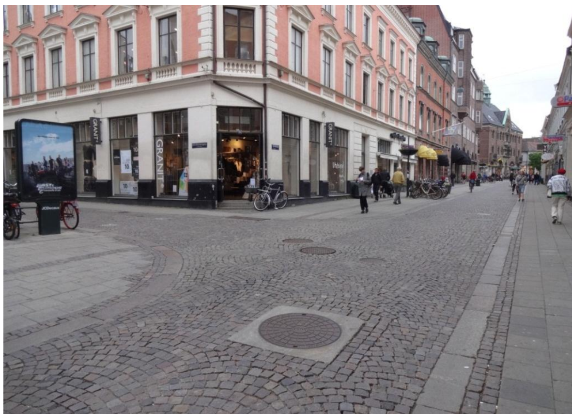
Figur 6.8 Eksempel på T-kryds mellem to shared space områder. Der er tilstræbt en fysisk udformning, der ikke signalerer prioritering, og dermed er der højrevigepligt. Anvendelse af chaussésten i sidegadens kørespor er til gene for mennesker med bevægehandicaps, der skal krydse sidegaden (Malmö, Sverige) (Foto: Rambøll).
