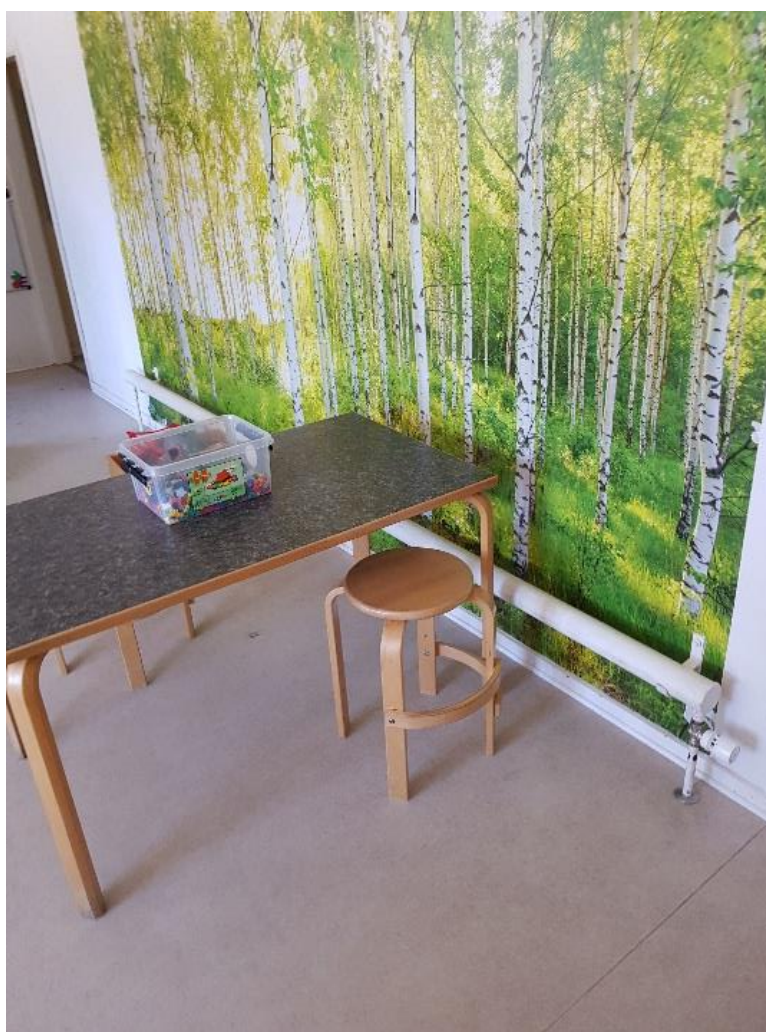
Denne radiator type er særligt dårlig ved lavtemperatur!
