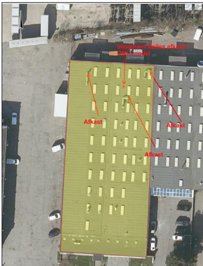
Figur 6.1: Afkast hos JS Ventilation.
