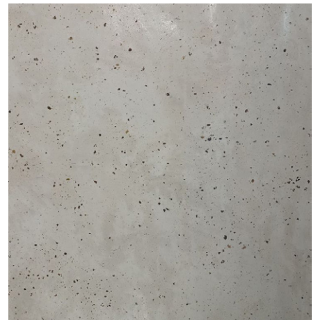
Glat slebet Eksempel på glat poleret beton.
