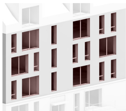
Vinduer med skift i vinduessætning, hvor vinduer bytter plads fra etage til etage jf. § 6
