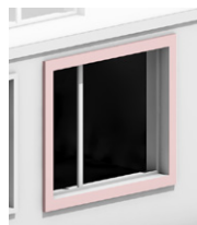
Vindue med detaljering i facademateriale med reliefvirkning på dybde på min. 2 cm jf. § 6. Her vist med muret rulleskifte eller opmuret reces
