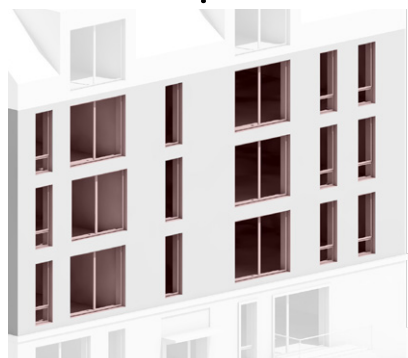
Vinduer placeret under hinanden fra etage til etage jf. § 6
