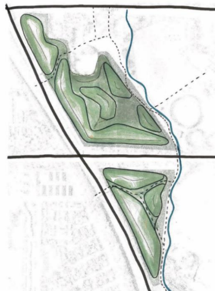
Figur 8: Landskabet udføres med støjvolde ud mod motorvejen, og et bakkedrag med lokale højderygge inde i landskabet. Illustrationen viser ikke de enkelte støjvoldes faktiske placering, men er blot en principskitse
