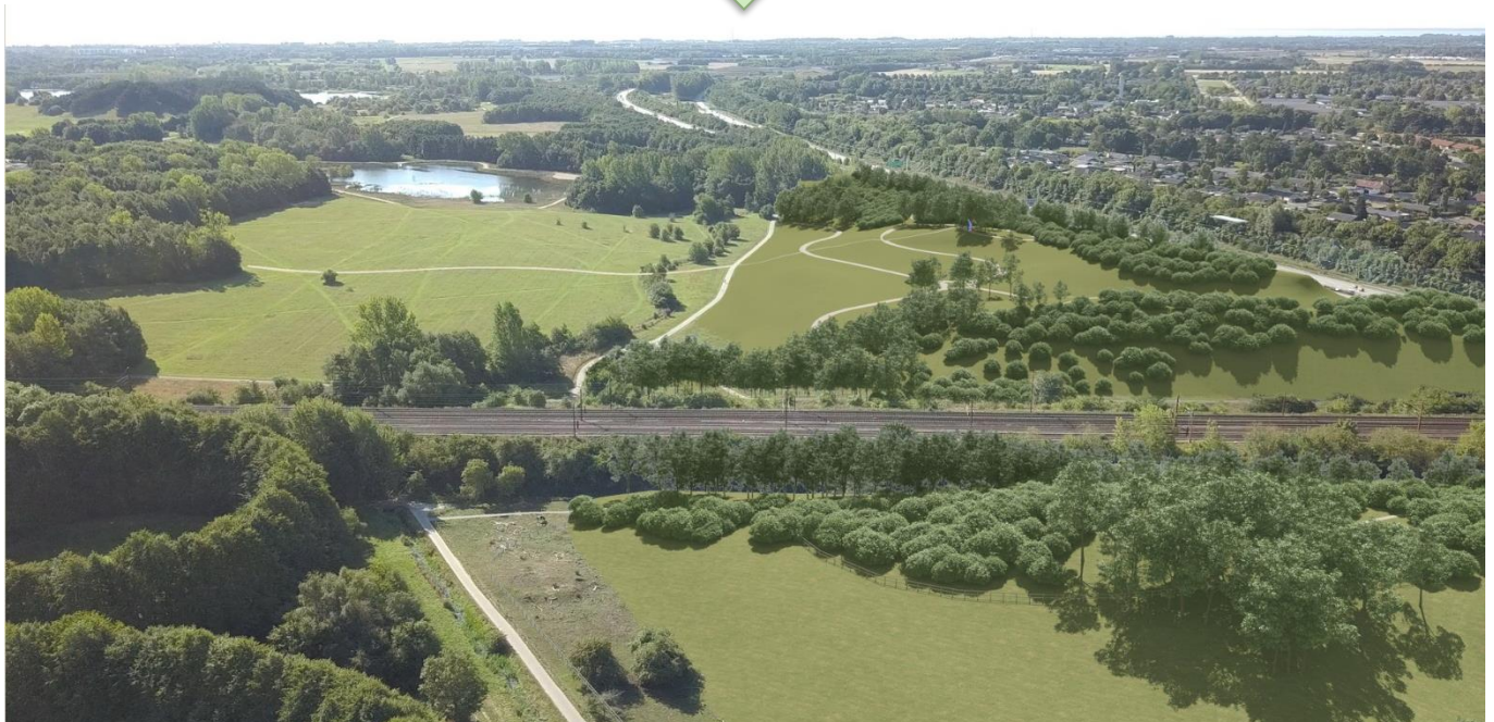
Figur 12: Landskabet som det ser ud før og efter lokalplanens realisering, her set fra Hyldagerparken nord for jernbanen, mod syd. Ud mod motorvejen etableres en støjvold med en højde op til 18 m over motorvejen (t.h. i billedet). På toppen af støjvolden etableres en tæt beplantning af lavtvoksende træer og buske, der afgrænser parkerne og danner et veldefineret rum. Det øvrige landskab udføres som et bakkelandskab, primært bestående åbne engarealer, der hænger sammen med de tilgrænsende græs- og engarealer uden for lokalplanområdet. I bakkelandskabet plantes større enkeltstående solitærtræer, samt mindre tætbeplantede lunde bestående af buske og små træer.
