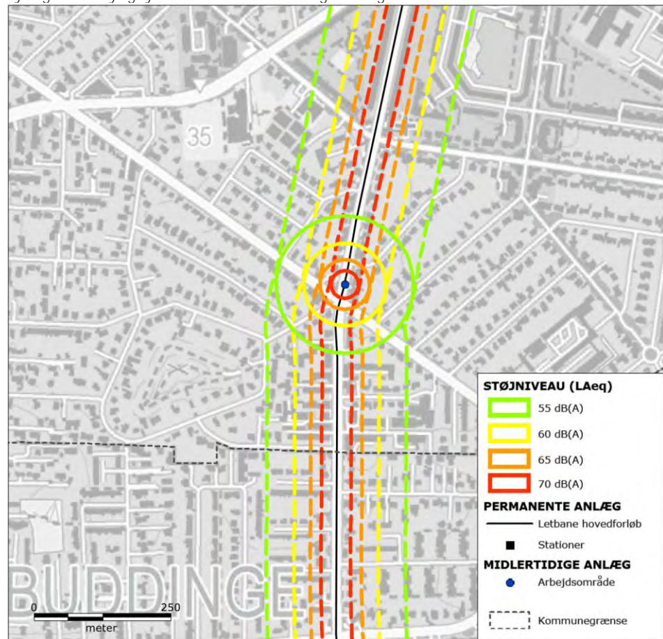
Bilag 3.c-6 | Støjkort for ombygning af vejanlæg og etablering af køreledningsanlæg i sydlig del af Lyngby-Taarbæk Kommune og nordlig del af Gladsaxe Kommune.
