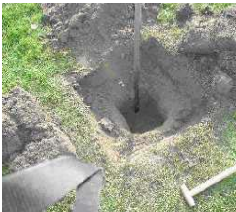
Der hældes ca. 0,05 m grus i bunden af prøvehullet.
