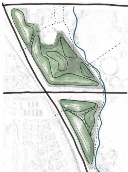
Figur 4-3. Principskitse af støjvolde og bakke­drags udformning. Landskabet udføres med støjvolde ud mod motorvejen og et bakke­drag med lokale højderygge inde i landskabet.
