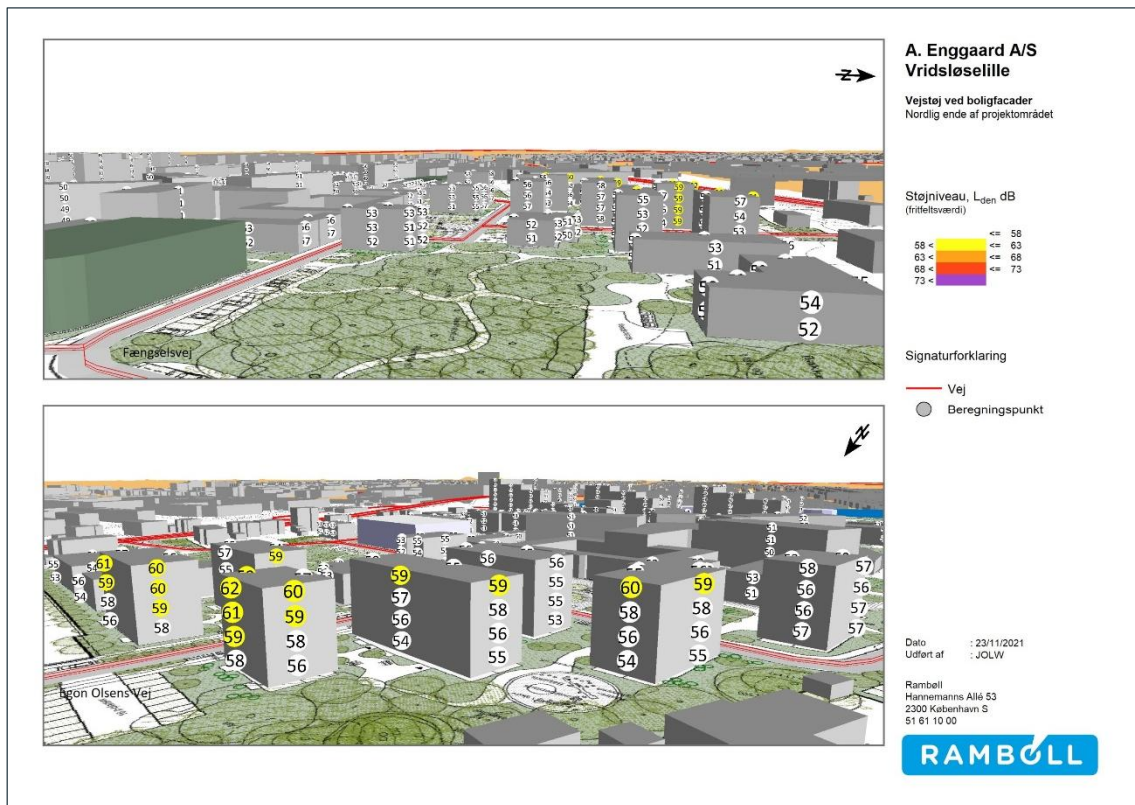
Figur 4. Vejstøjen på facaderne af de nordligst beliggende boliger set fra henholdsvis øst (Albertslundvej) og fra nordvest.
