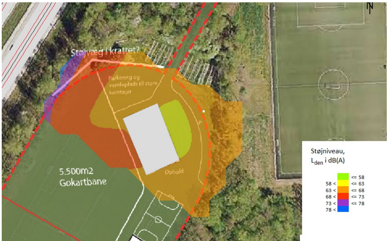
B) 4 m bygning + 5 m skærm (skal være absorberende ind imod området, ellers forværres den bare problemet)
