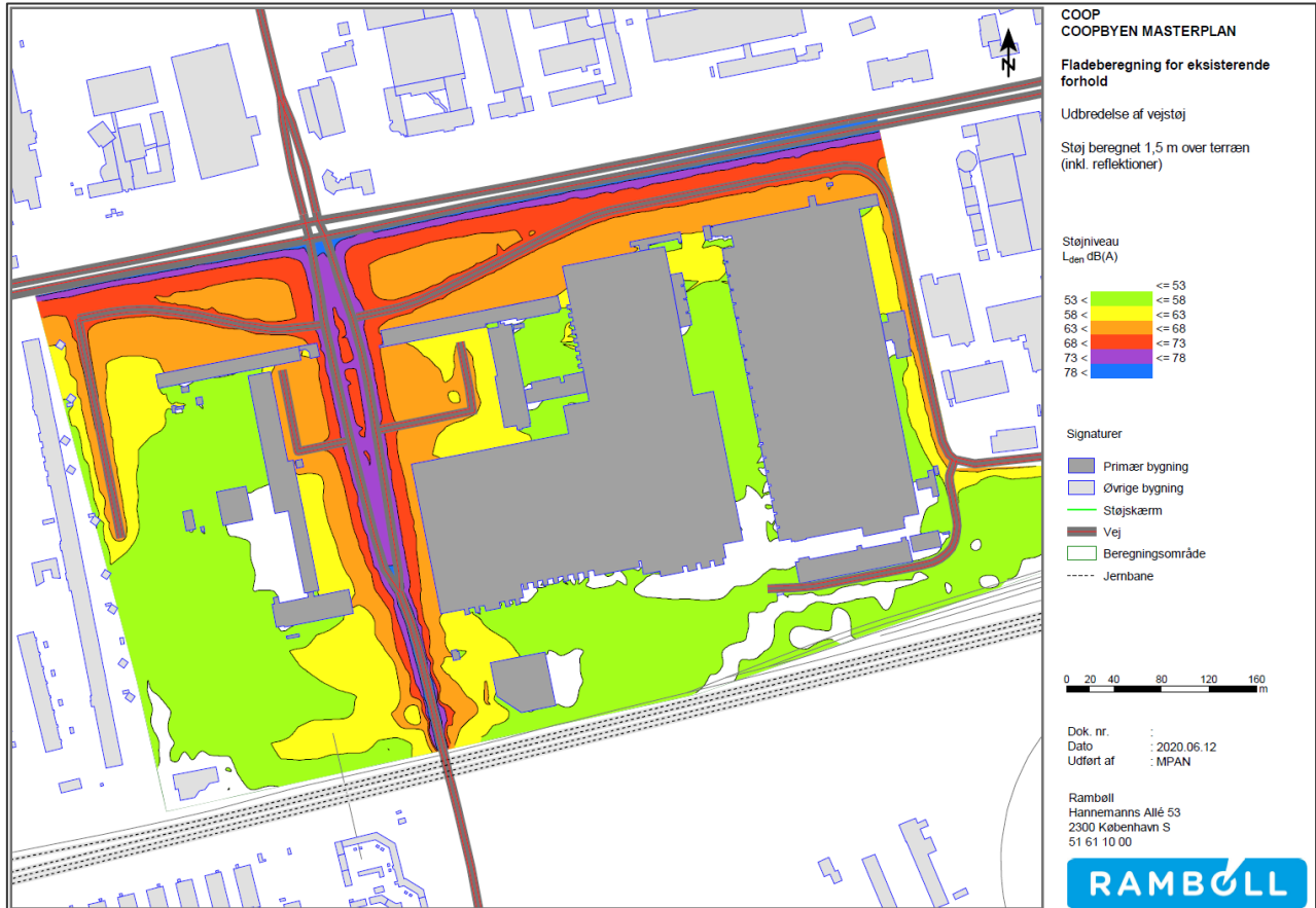
Figur 1-2 Støjudbredelseskort for støj fra vejtrafik for eksisterende forhold (beregnet 1,5 meter over terræn).
