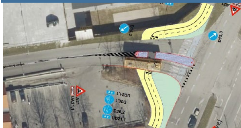
Figur 51. Principskitse for tilbagetrækning af stikrydsning, vigepligt pålagt stitrafikanter (Via Trafik, 2017)
