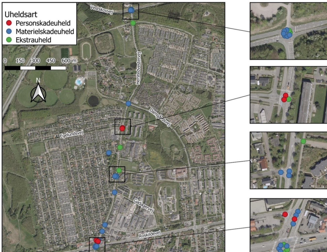
Figur 6. Lokalisering af alle uheld langs Herstedvestervej fordelt på uhedsarten fra 2014-2018. Detaljerede kortudsnit af kryds med flere uheld ses til højre.
