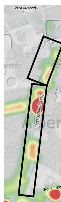
Figur 38. Støjreducerende asfalt anbefales hvor der er målt forhøjet støjniveau i de tre definerede områder som ses med sort firkant på støjkortet.
