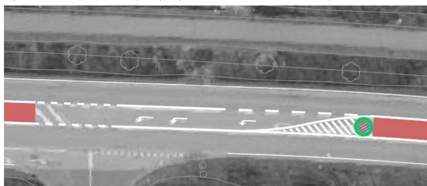
Figur 35. Eksempel på svingbane i midterarealet med midterhelle der markerer en ændring i vejforløbet.
